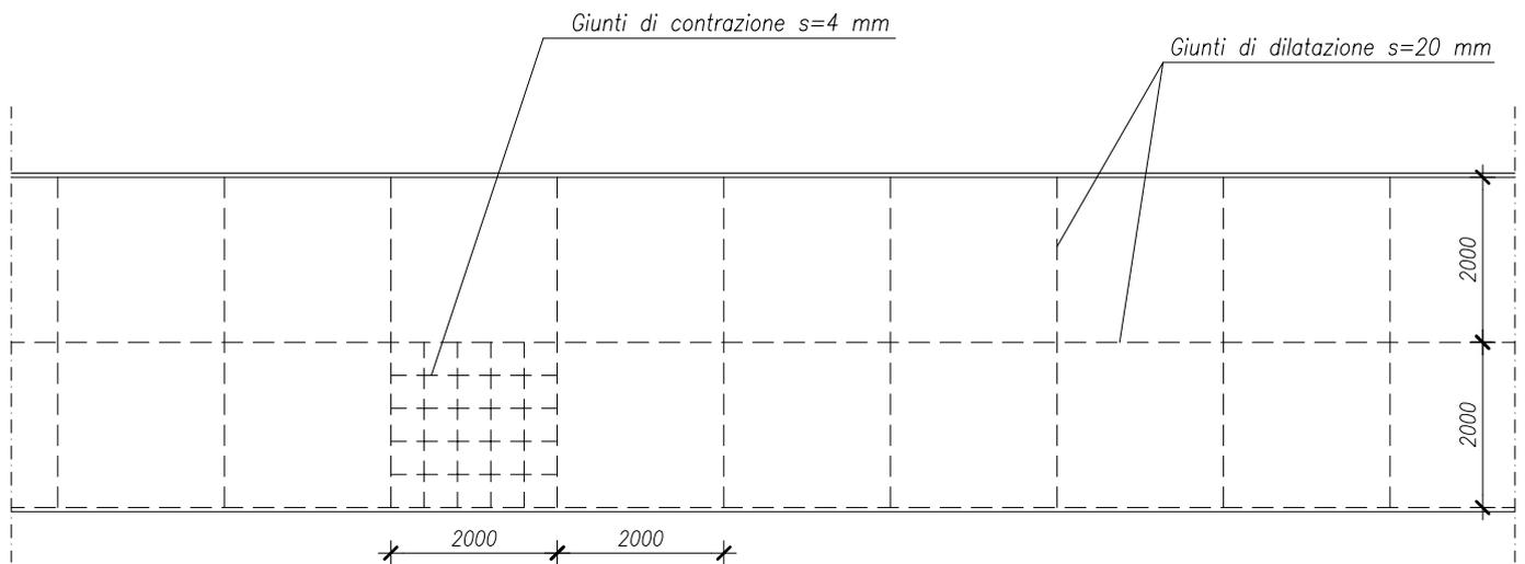
**PAVIMENTAZIONE IN CLS: GIUNTI DI DILATAZIONE**
