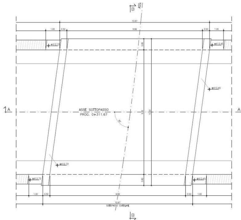
Fig. 4.12: Scatolare - Pianta superiore
