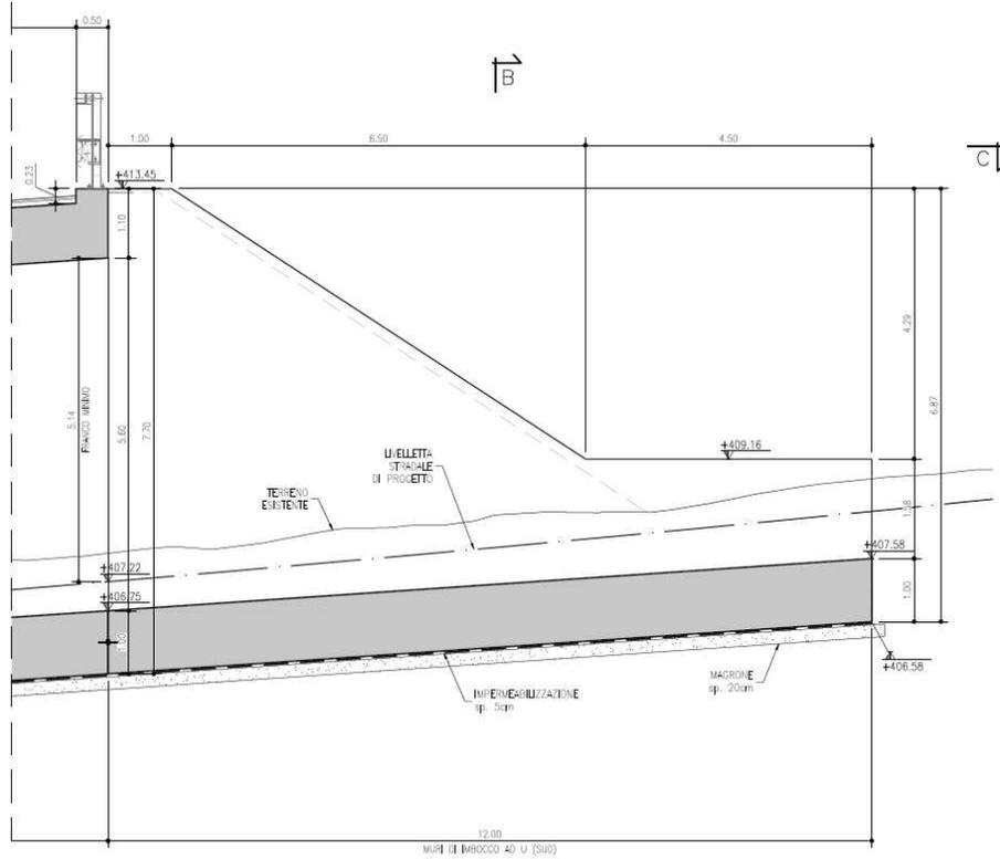
Fig. 4.17: Muri d'imbocco - Sezione longitudinale
