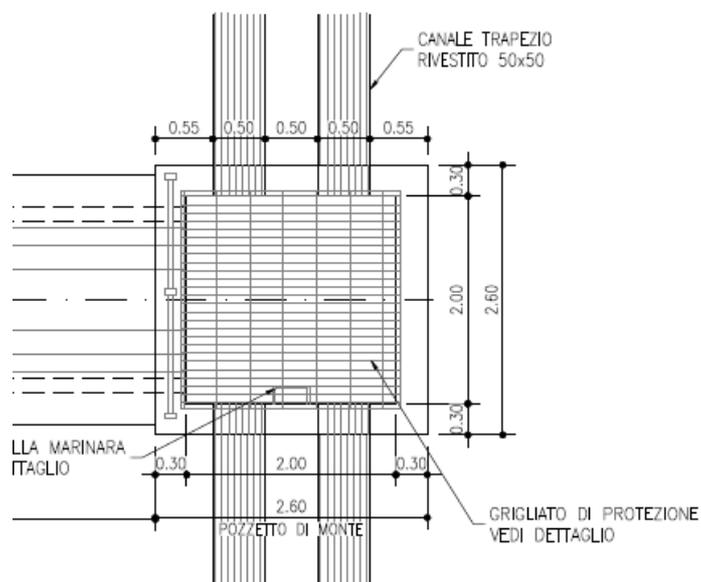
*Fig. 4.8: Manufatto d'imbocco - Pianta*
