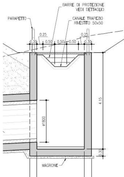
Fig. 4.7: Manufatto d'imbocco - Sezione longitudinale
