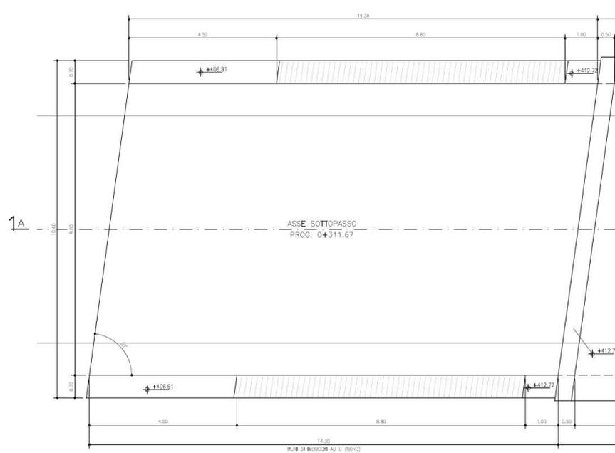
*Fig. 4.16: Muri di sbocco - Pianta*
