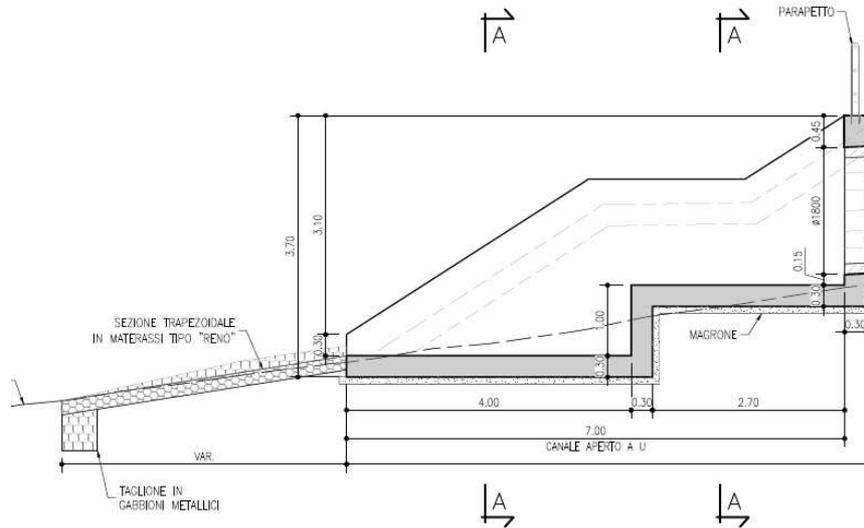
Fig. 4.4: Manufatto di sbocco - Sezione longitudinale
