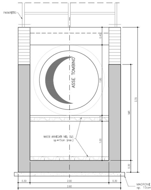
Fig. 4.5: Manufatto di sbocco - Sezione trasversale
