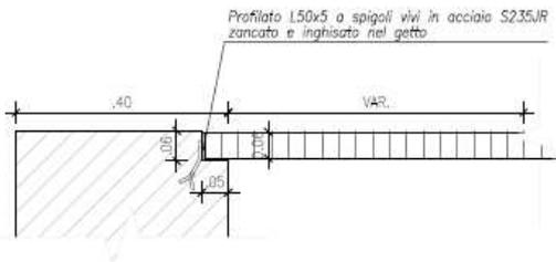
*Dettaglio grigliato elettrosaldato*
