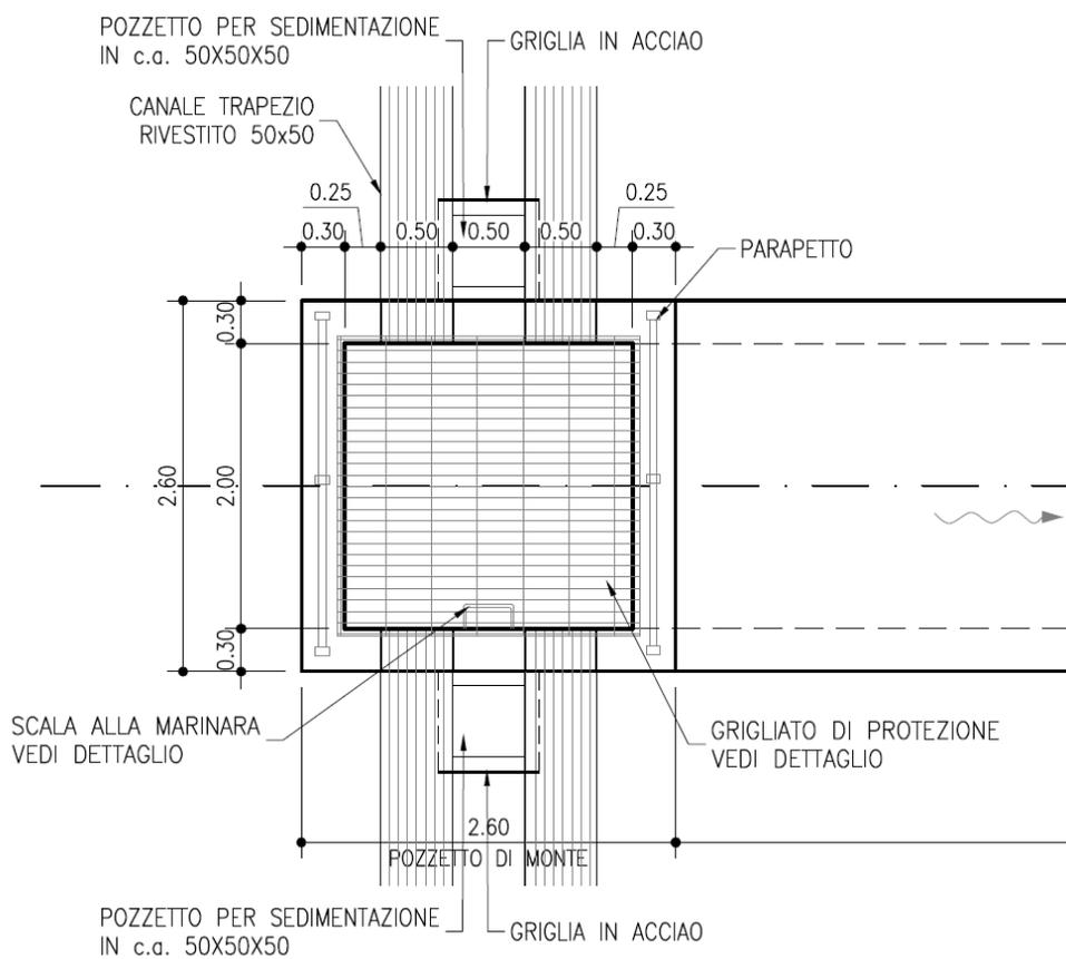
*Fig. 4.9 Pozzetto per sedimentazione*
