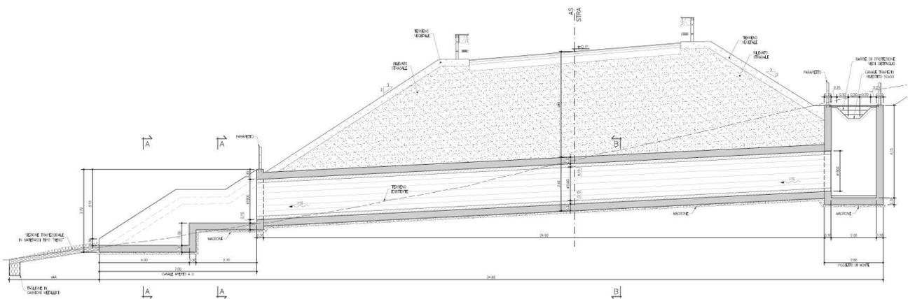
Fig. 4.1: Tombino circolare - Sezione longitudinale
