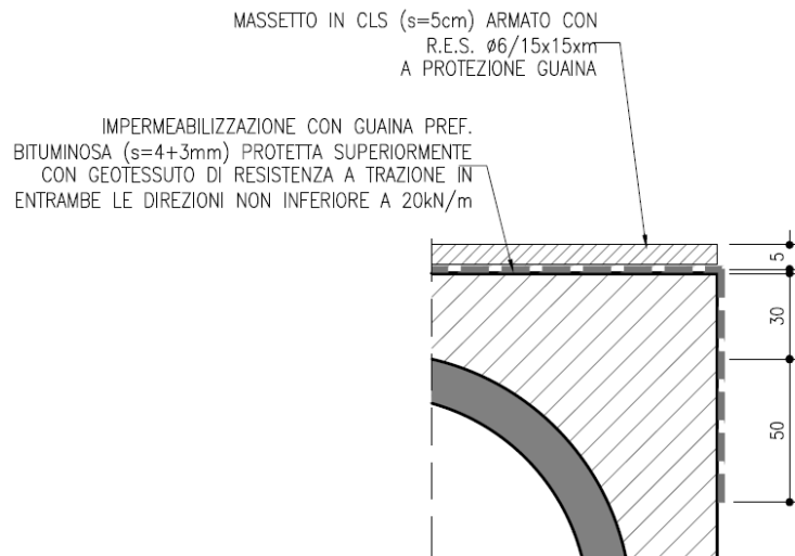
Figura 12 Impermeabilizzazione superiore del tombino circolare
