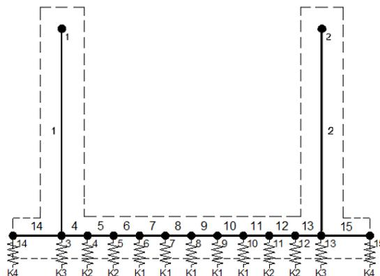
La soletta inferiore viene divisa in elementi per poter schematizzare, tramite molle applicate, l'interazione terreno- struttura.
