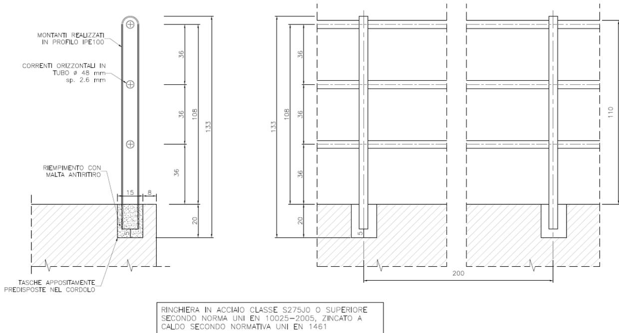
*Figura 9 Parapetto metallico*
