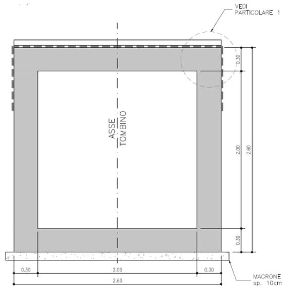
Figura 2 Tombino scatolare - sezione trasversale
