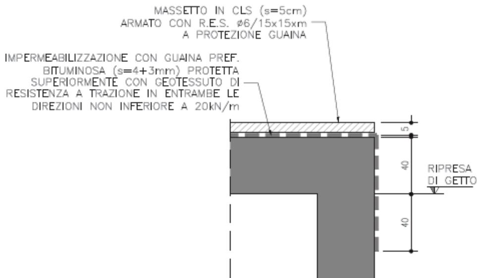
*Figura 10 Impermeabilizzazione superiore del tombino scatolare*
