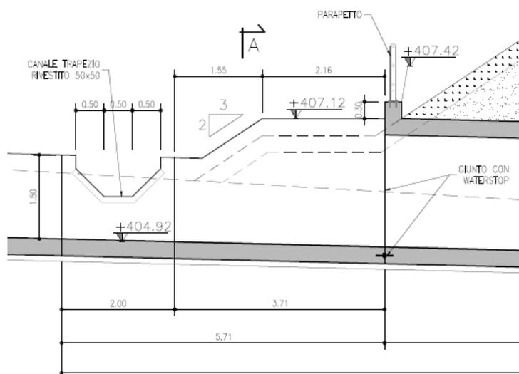
Figura 6 Muri d'imbocco - Sezione longitudinale
