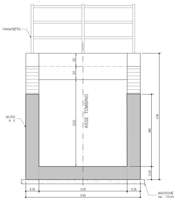
Figura 7 Muri d'imbocco - Sezione longitudinale
