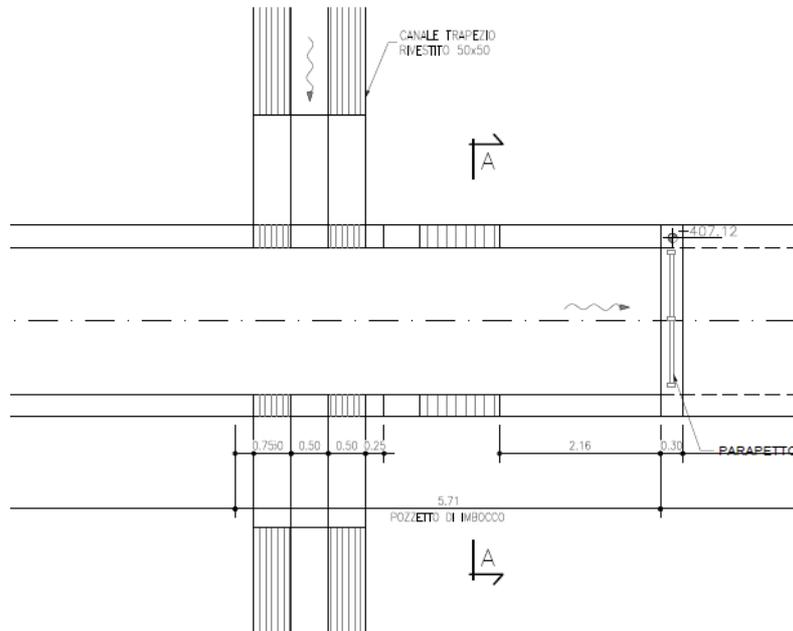
*Figura 8 Muri d'imbocco - Pianta*
