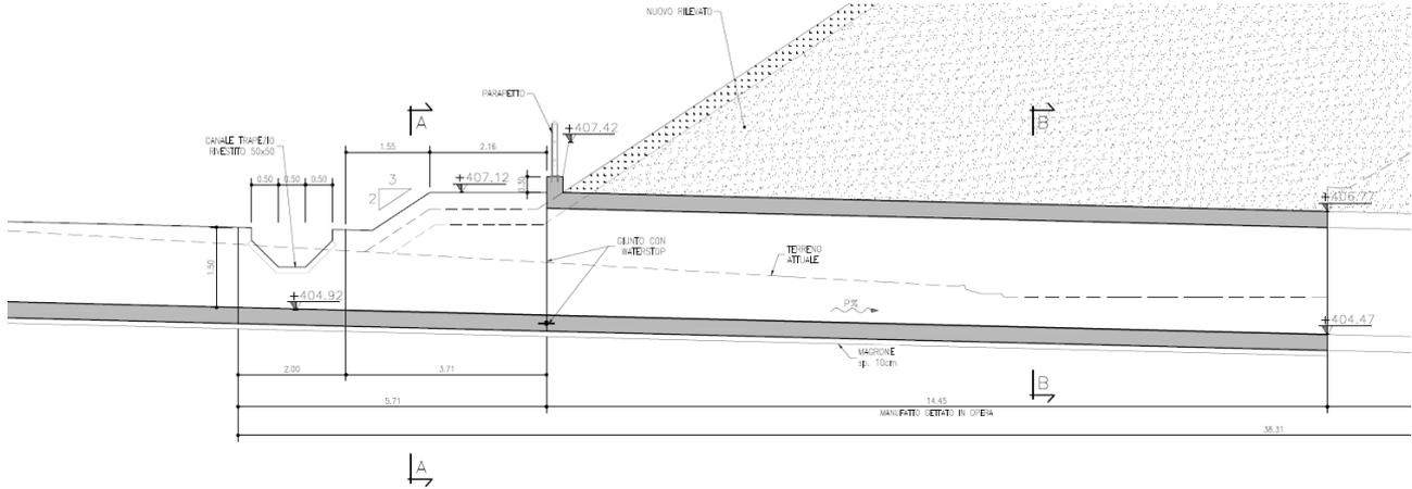
*Figura 3 Tombino scatolare – Sezione longitudinale*
