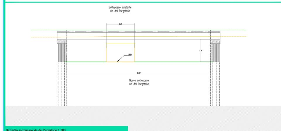
Dettaglio sottopasso via del Purgatorio 1:200
