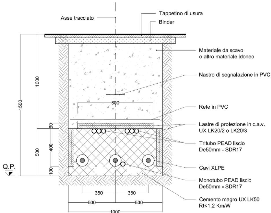
Figura 7.7/6 – Posa su strade urbane ed extraurbane – cavo 245 kV e 420kV in piano
