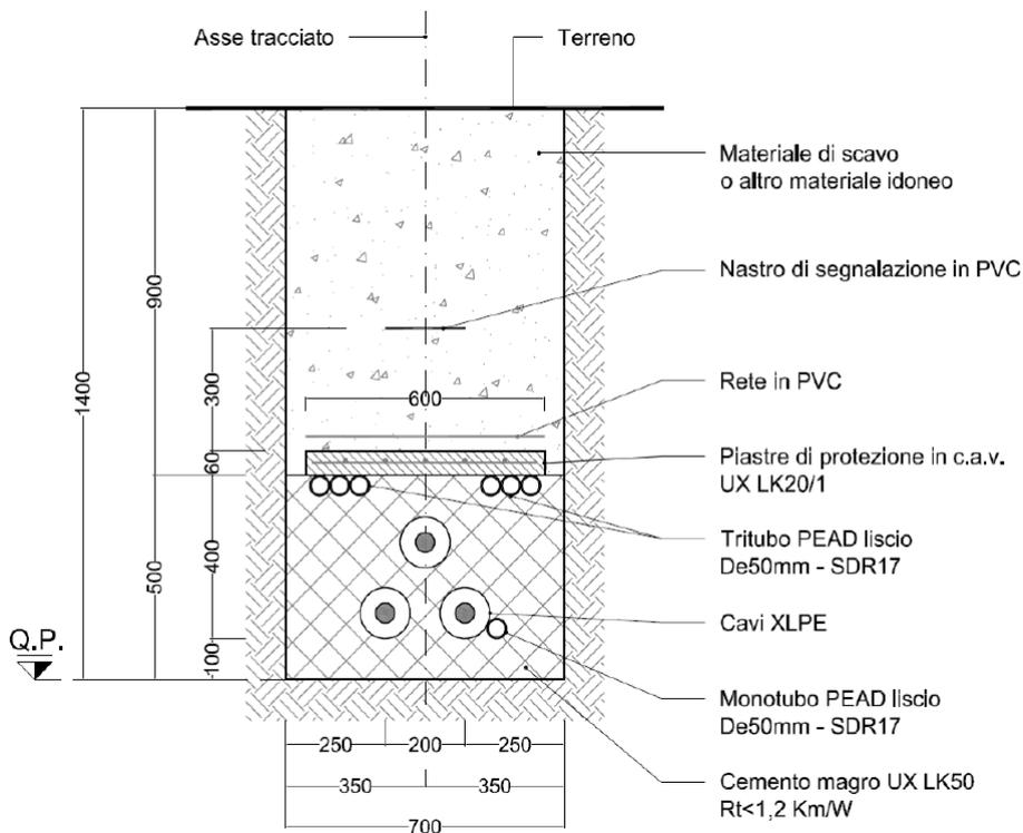
Figura 7.7/14– Posa in roccia – cavo 170 kV e 245 kV a trifoglio allargato
