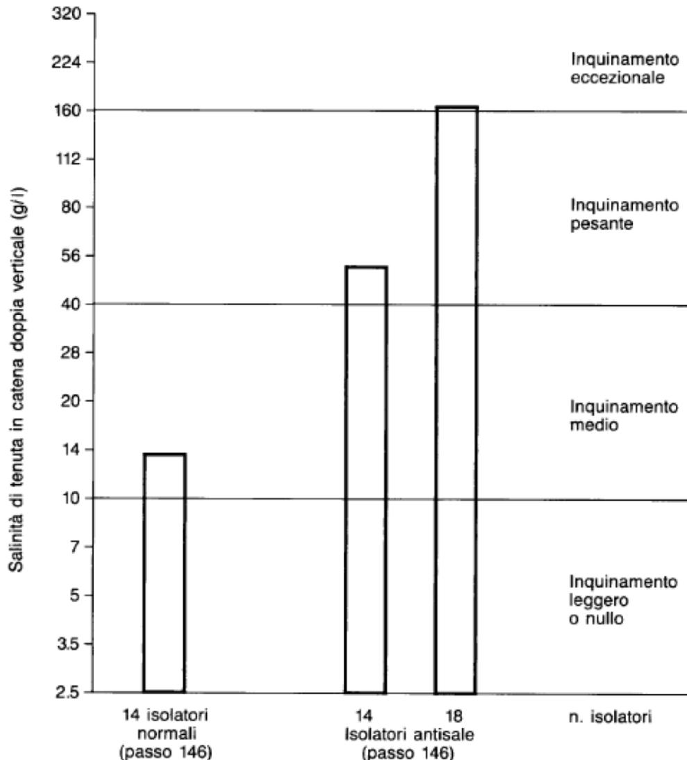
Per le linee che attraversano zone prive di inquinamento atmosferico è previsto l'impiego di catene (di sospensione o di amarro) composto da 14 elementi di tipo “normale”.
