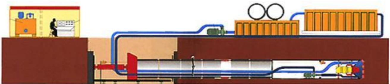
Figura 7.7/20 - Schematico di perforazione con microtunneling
