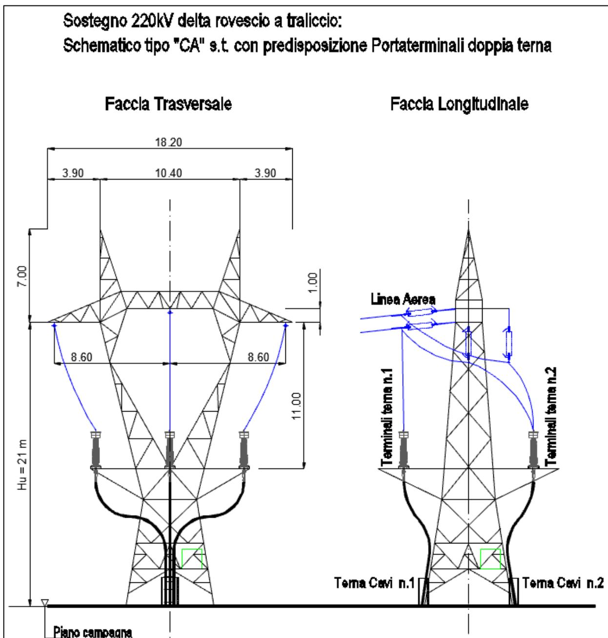
Figura 7.8/1 – Schematico sostegno portaterminali con testa a delta
