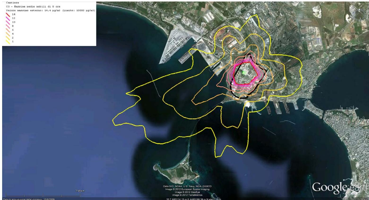
**Figura 2. Fase di cantiere - Isolivelli di concentrazione corrispondenti alle massime medie mobili di 8 ore di CO**
