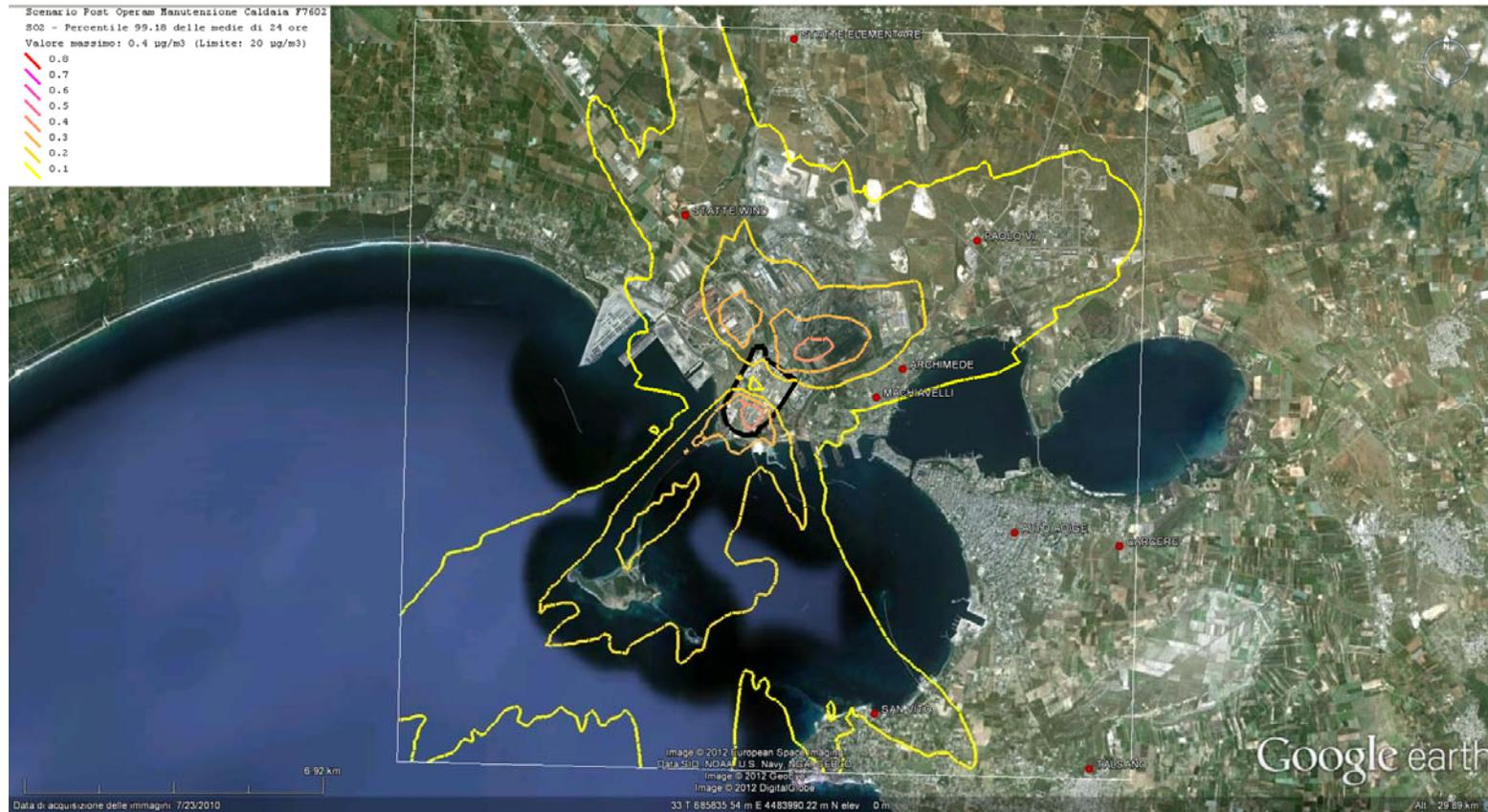
**Figura 22. Fase di esercizio POST OPERAM MANUTENZIONE CALDAIA F7602 - Isolivelli di concentrazione corrispondenti al percentile 99.18 delle medie di 24 ore di SO2**
