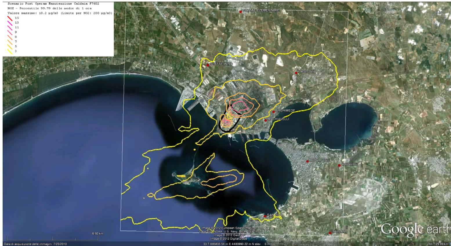
**Figura 19. Fase di esercizio POST OPERAM MANUTENZIONE CALDAIA F7602 - Isolivelli di concentrazione corrispondenti al percentile 99.79 delle medie di 1 ora di NOX**
