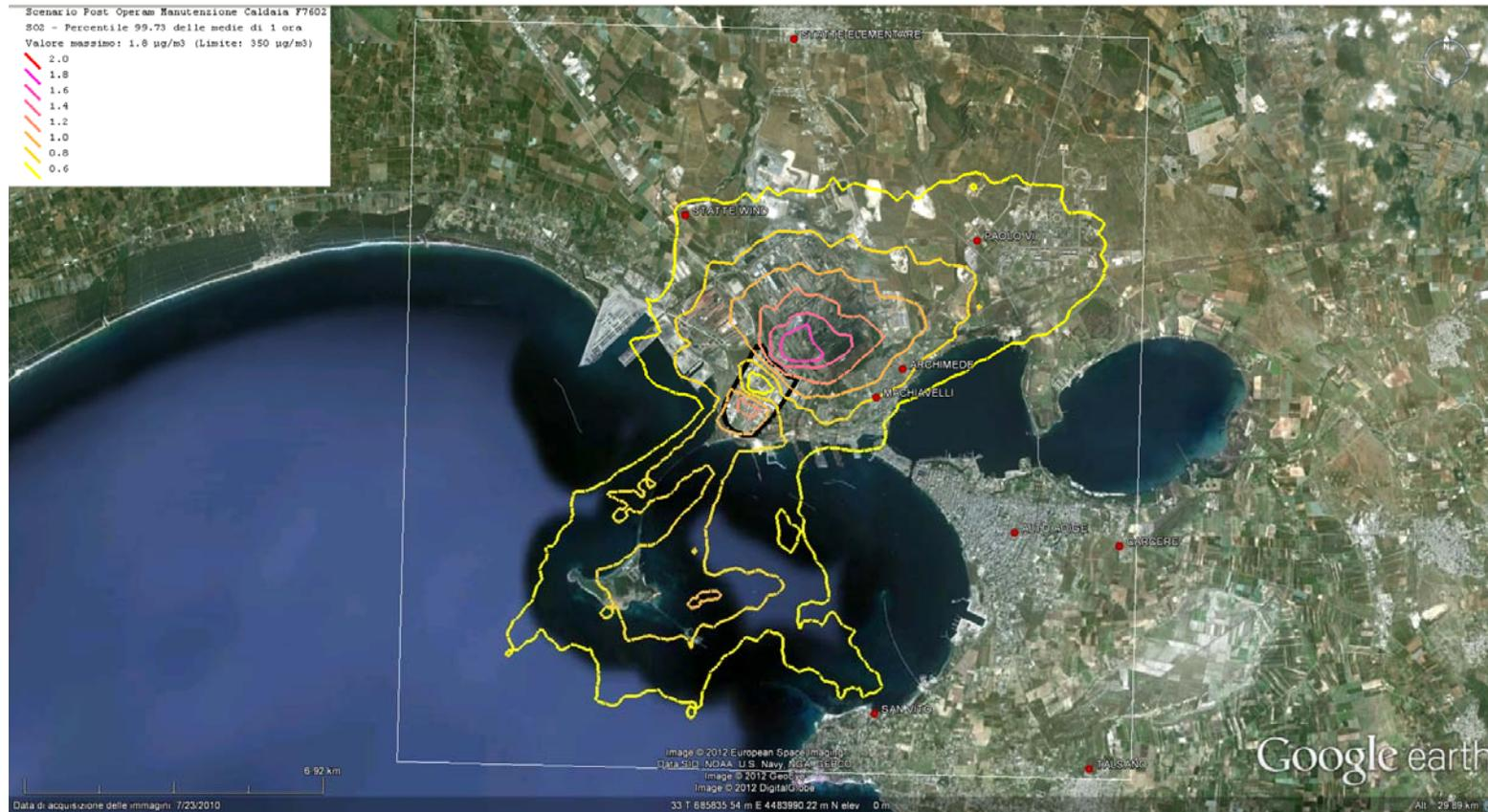
**Figura 21. Fase di esercizio POST OPERAM MANUTENZIONE CALDAIA F7602 - Isolivelli di concentrazione corrispondenti al percentile 99.73 delle medie di 1 ora di SO2**
