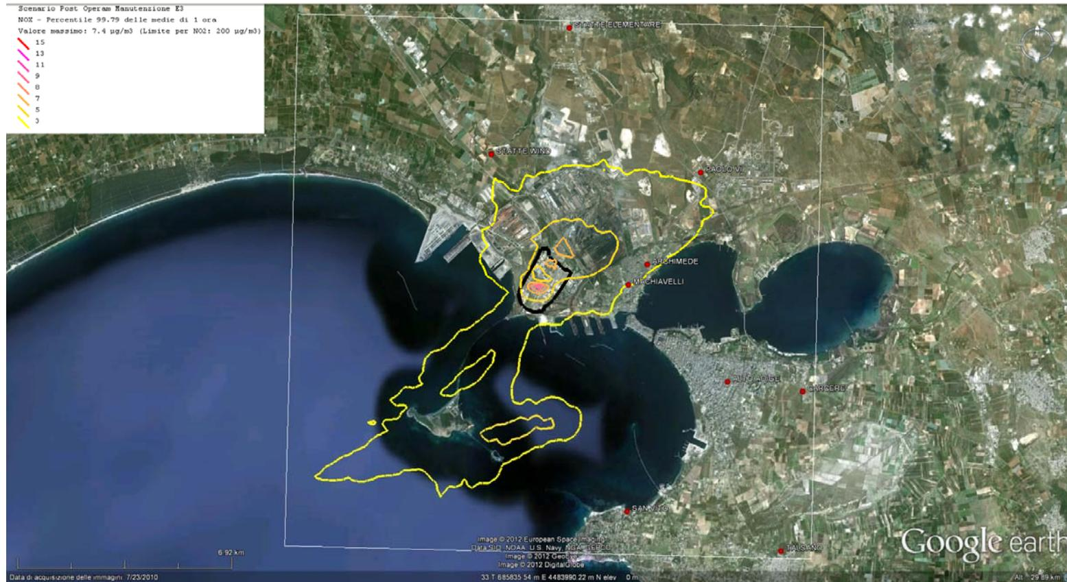
**Figura 23. Fase di esercizio POST OPERAM MANUTENZIONE E3 - Isolivelli di concentrazione corrispondenti al percentile 99.79 delle medie di 1 ora di NOx**
