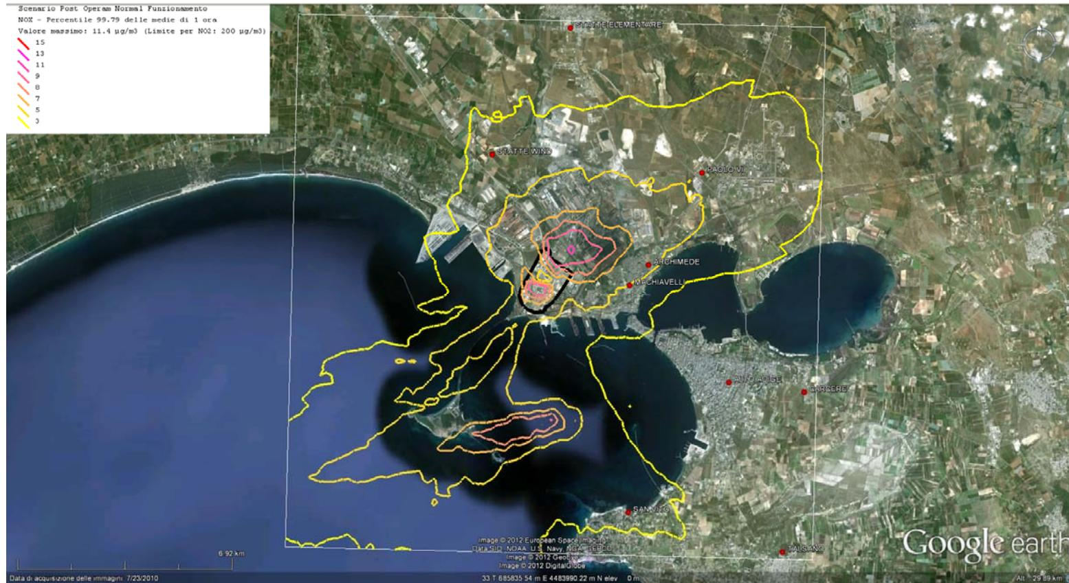
**Figura 13. Fase di esercizio POST OPERAM NORMAL FUNZIONAMENTO - Isolivelli di concentrazione corrispondenti al percentile 99.79 delle medie di 1 ora di NOX**
