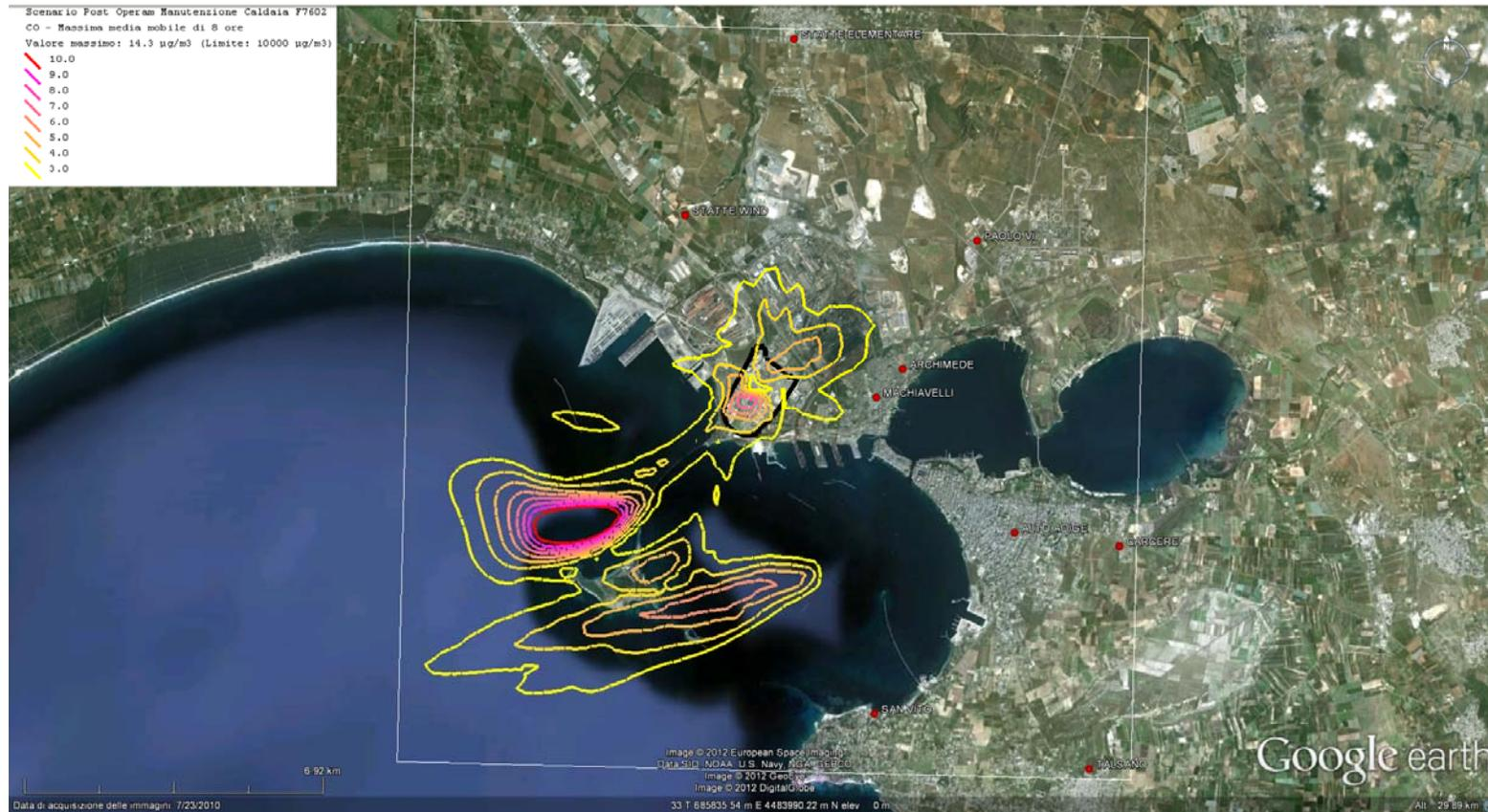
**Figura 20. Fase di esercizio POST OPERAM MANUTENZIONE CALDAIA F7602 - Isolivelli di concentrazione corrispondenti alle massime medie mobili di 8 ore di CO**
