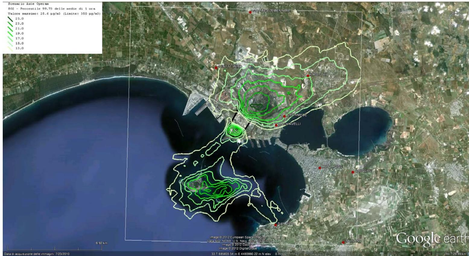
**Figura 8. Fase di esercizio ANTE OPERAM - Isolivelli di concentrazione corrispondenti al percentile 99.73 delle medie di 1 ora di SO2**
