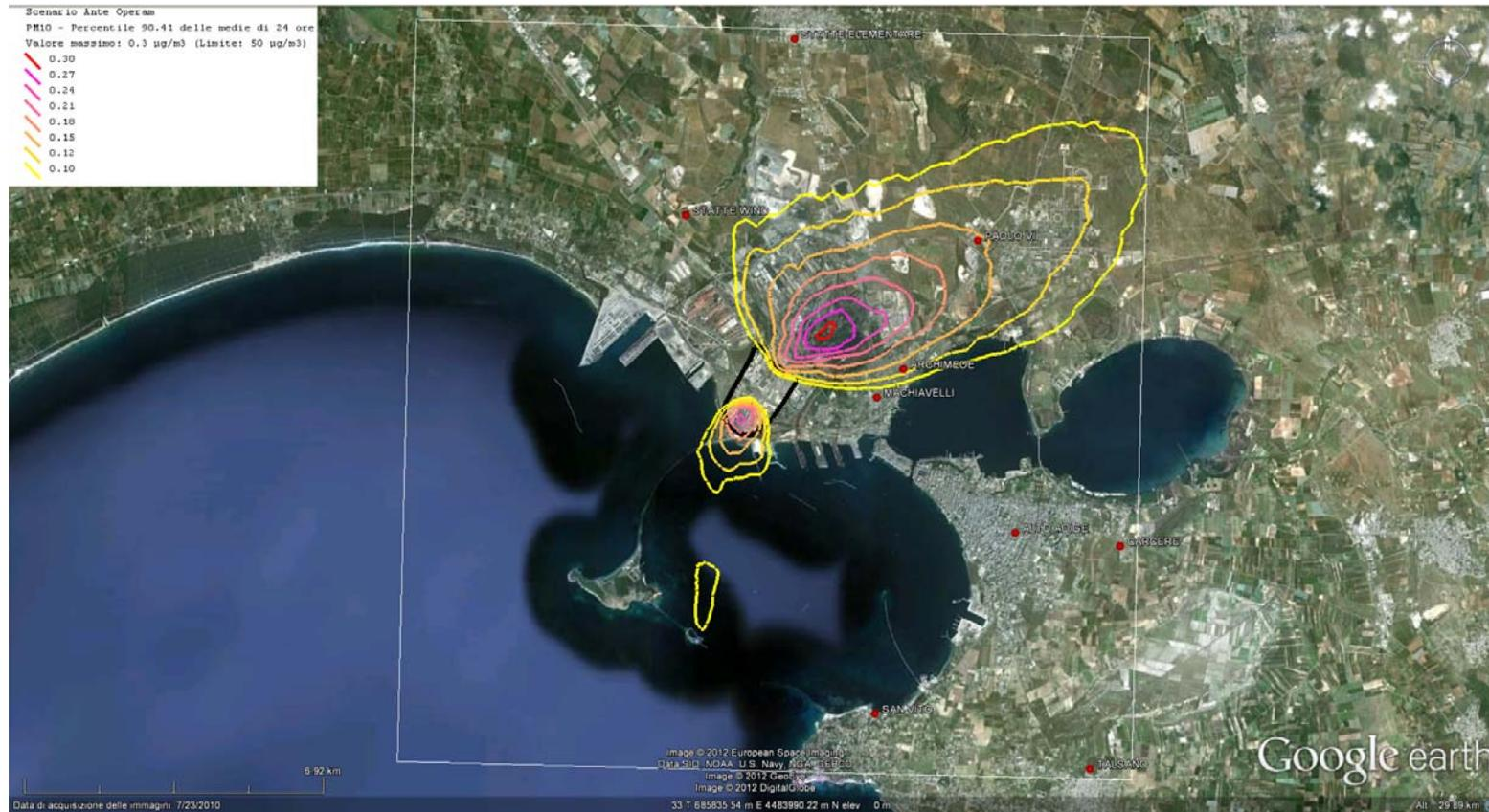
**Figura 11. Fase di esercizio ANTE OPERAM - Isolivelli di concentrazione corrispondenti al percentile 90.41 delle medie di 24 ore di PM10**
