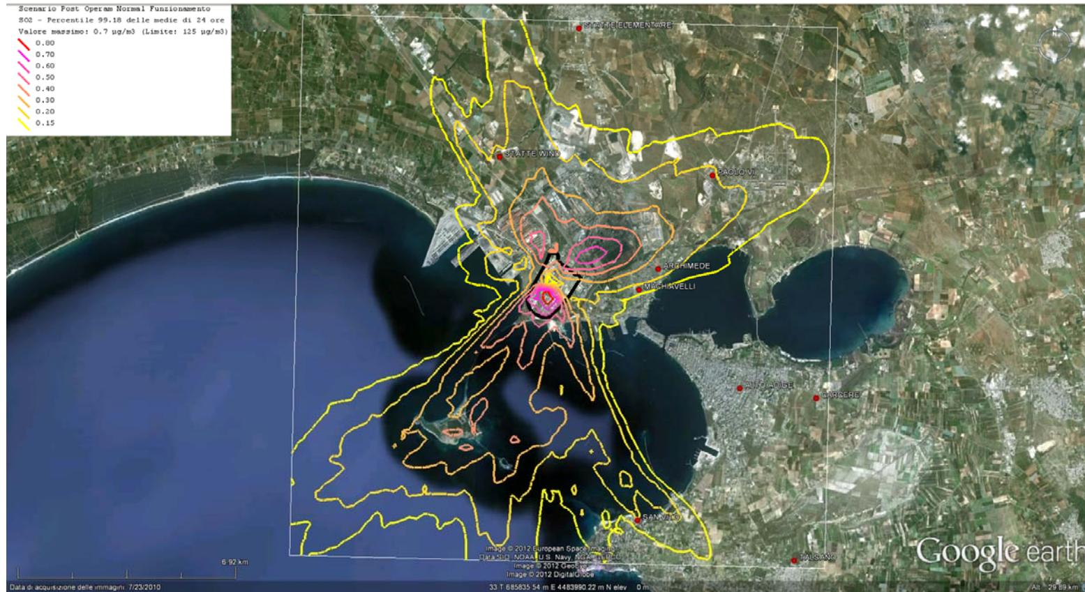
**Figura 17. Fase di esercizio POST OPERAM NORMAL FUNZIONAMENTO - Isolivelli di concentrazione corrispondenti al percentile 99.18 delle medie di 24 ore di SO2**
