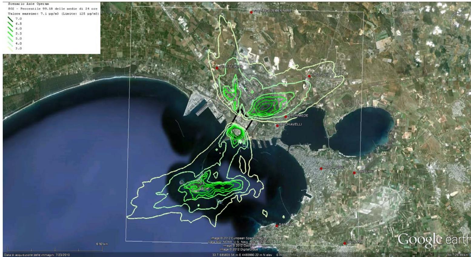
**Figura 9. Fase di esercizio ANTE OPERAM - Isolivelli di concentrazione corrispondenti al percentile 99.18 delle medie di 24 ore di SO2**
