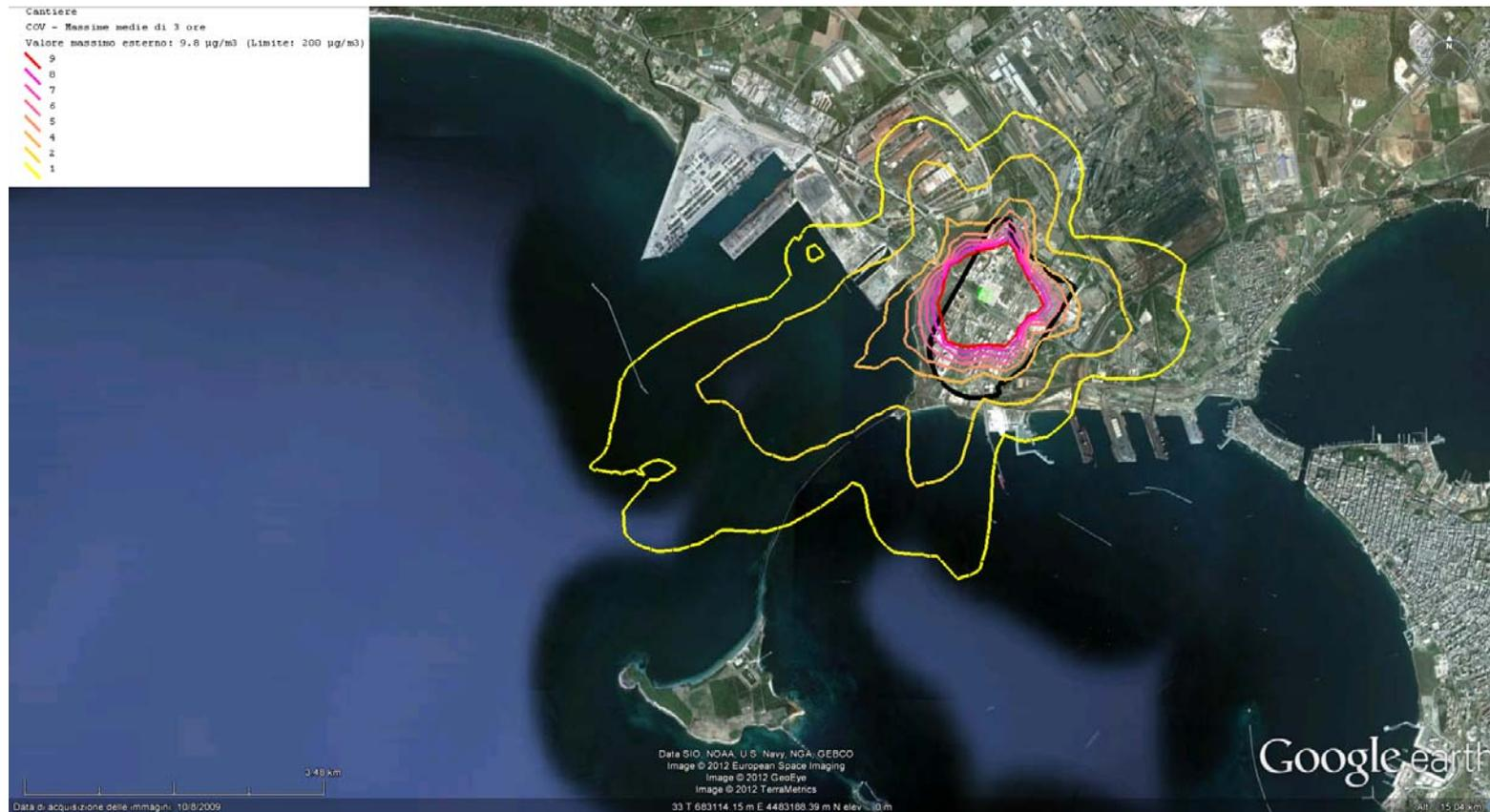
**Figura 4. Fase di cantiere - Isolivelli di concentrazione corrispondenti alle massime medie mobili di 3 ore di COV**
