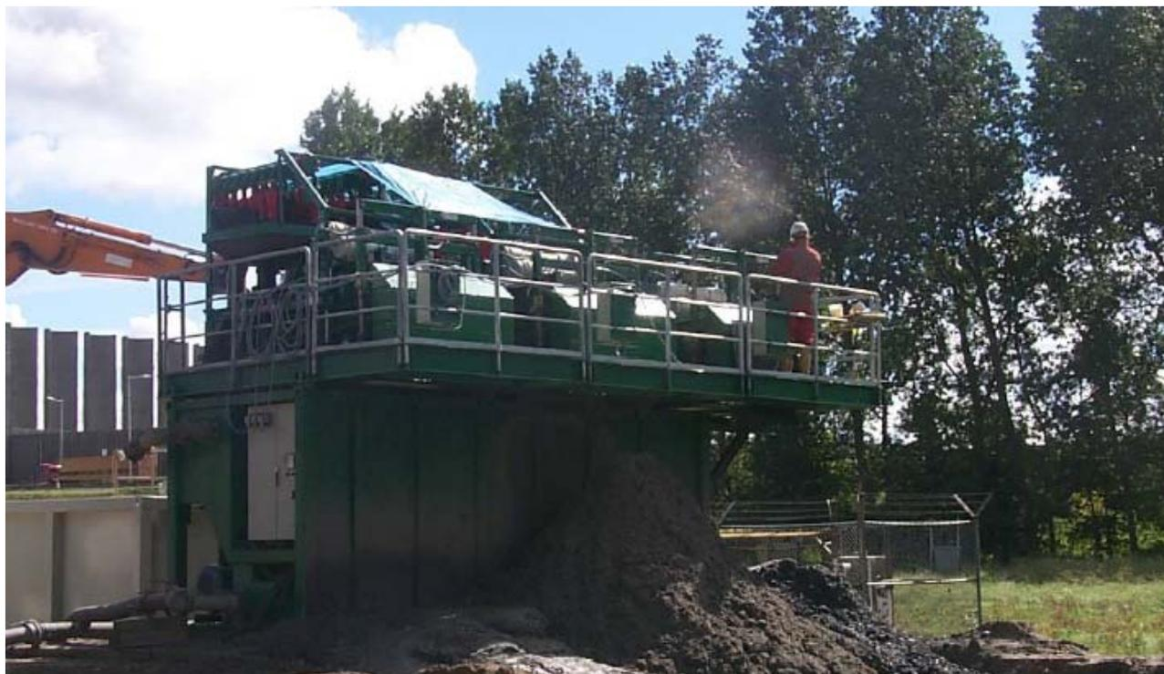
*Figura 4.3: unità di riciclo/separazione fanghi*
