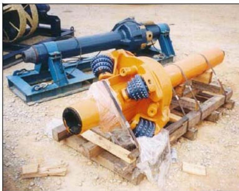
*Figura 4.8: fresa per l'alesaggio*
