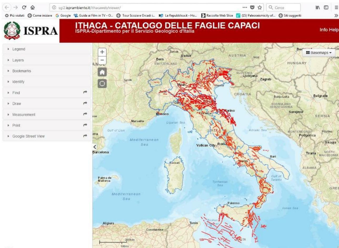
**Figura 4.31** Screen-shot del sito web di ITHACA (ITaly Hazard from CAPable faults; <http://sgi2.isprambiente.it/ithacaweb/viewer/>), Catalogo delle Faglie Attive e Capaci in Italia. Sono rappresentate le Faglie Capaci (attivate negli ultimi 125.000 anni) e Potenzialmente Capaci (attive nel Quaternario, ossia c.a. ultimi 2 Milioni di anni) note in letteratura in Italia
