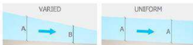
Figura 14: Confronto tra modello in moto vario e uniforme
