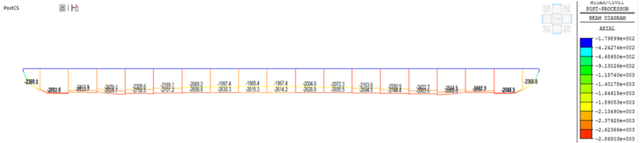
Figura 31 - Sforzo assiale in combinazione FREQUENTE (kN)
