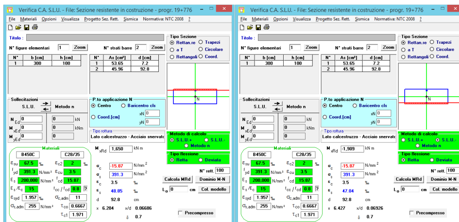
Figura 22 - Calcolo dei momenti resistenti SLU in direzione longitudinale cordolo di fondazione in fase di costruzione
