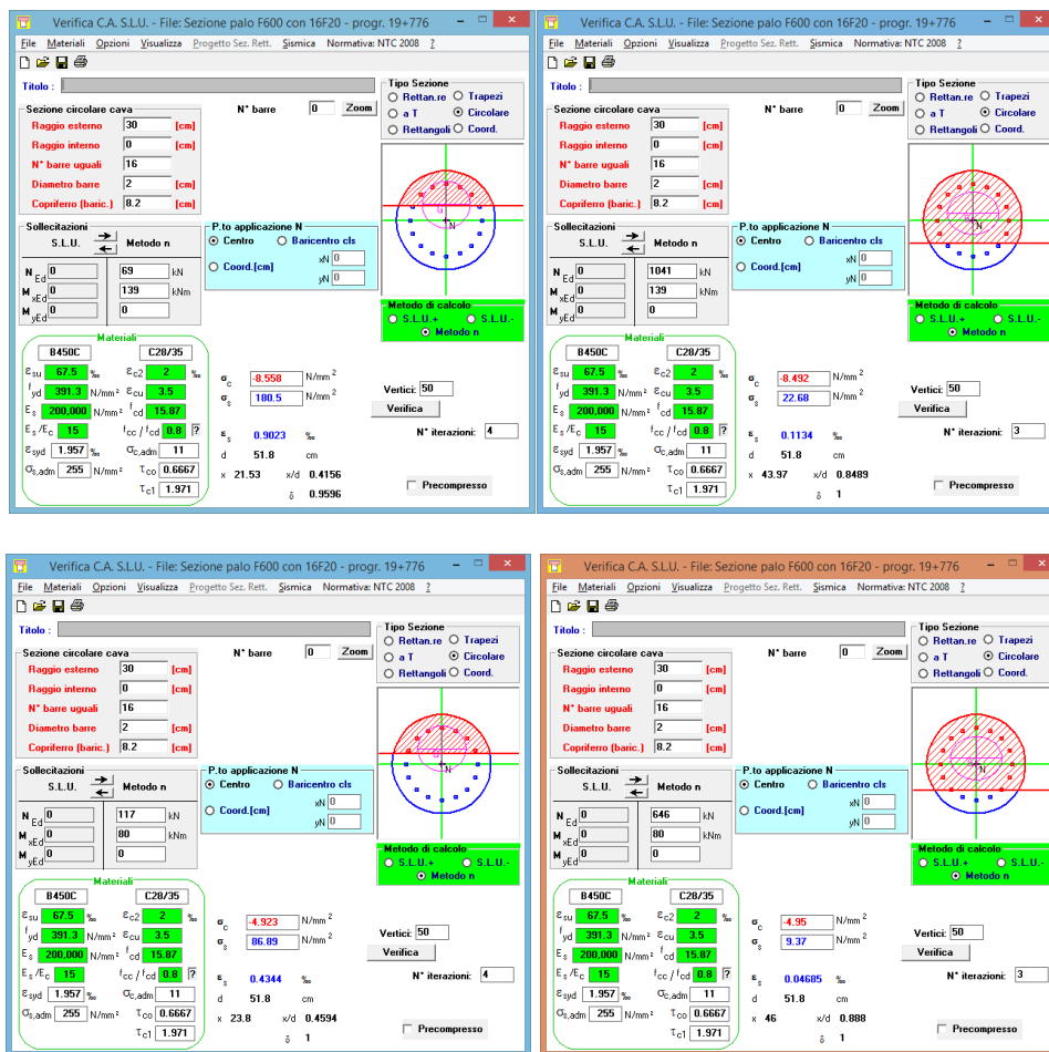
Figura 14 - Calcolo delle tensioni massime nel cls e nell'acciaio - comb. caratteristica rara e q.perm
