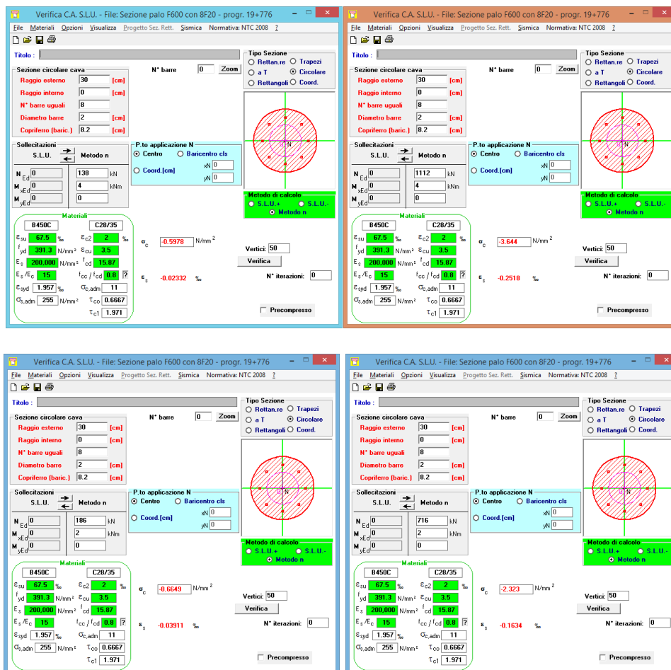
Figura 15 - Calcolo delle tensioni massime nel cls e nell'acciaio - comb. caratteristica rara e q.perm
