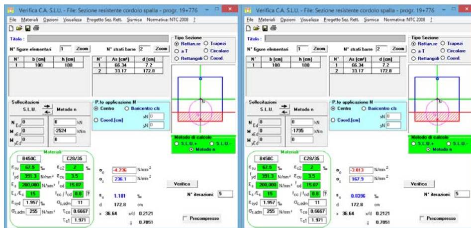
Figura 54 - Calcolo delle tensioni massime nel cls e nell'acciaio - comb. caratteristica rara e q.perm
