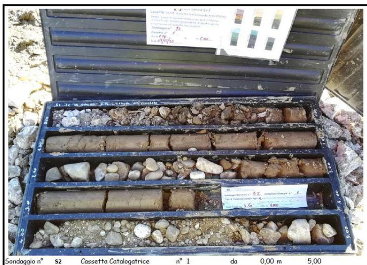
Figura 16. Materiali alluvionali terrazzati in corrispondenza della spalla – Sondaggio S2
