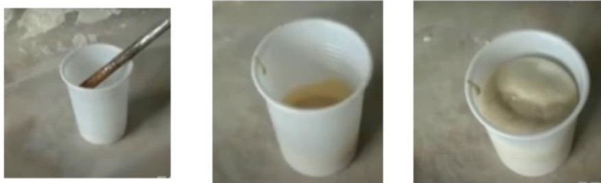
Figura 6: Passaggio dallo stato fluido a quello di schiuma della resina poliuretamica
