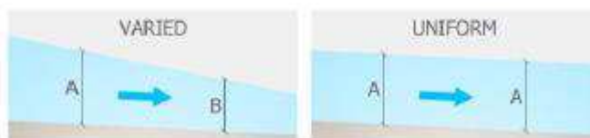
Figura 13: Confronto tra modello in moto vario e uniforme
