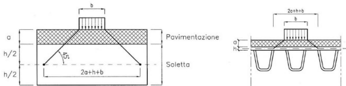
Figura 4 - Schemi di diffusione dei carichi concentrati nelle solette e negli impalcati a piastra ortotropa (NTC2008)
