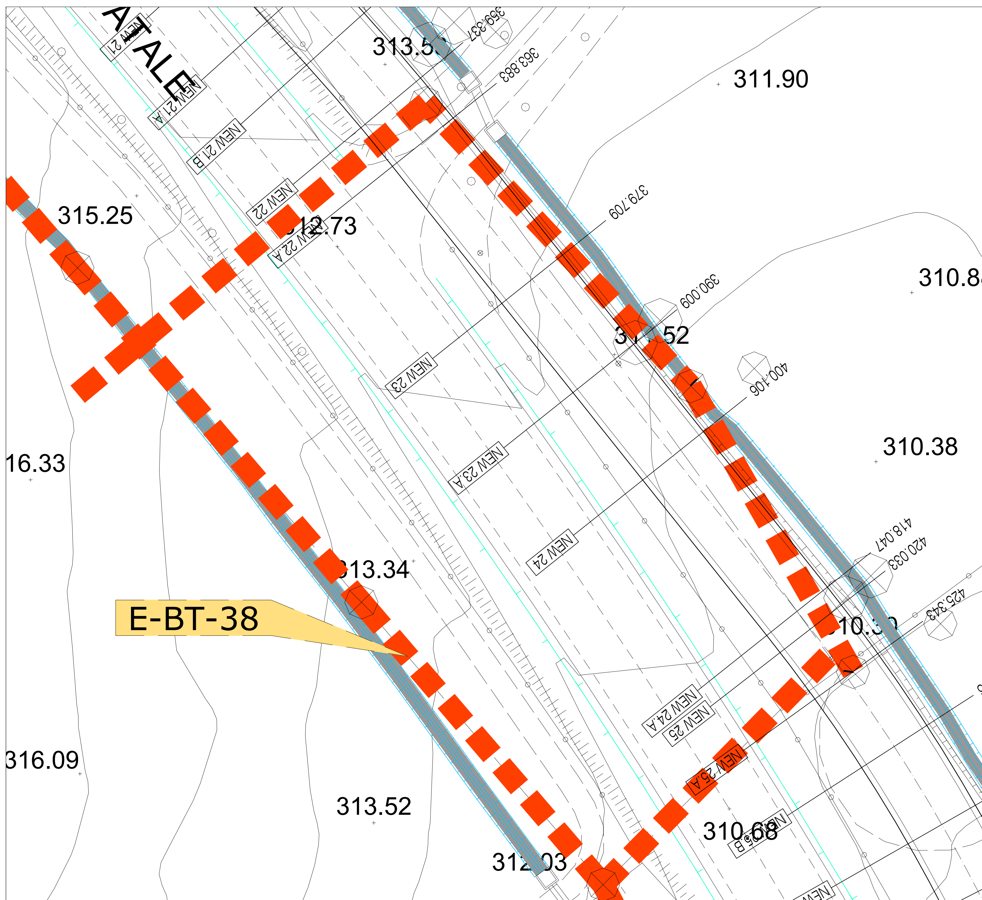
Viabilità Secondaria 37 NEW - Planimetria di progetto con individuazione linea Enel media tensione interferente
