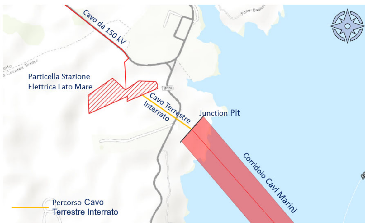
Figura 3.9: Ipotesi di percorso cavo terrestre interrato
