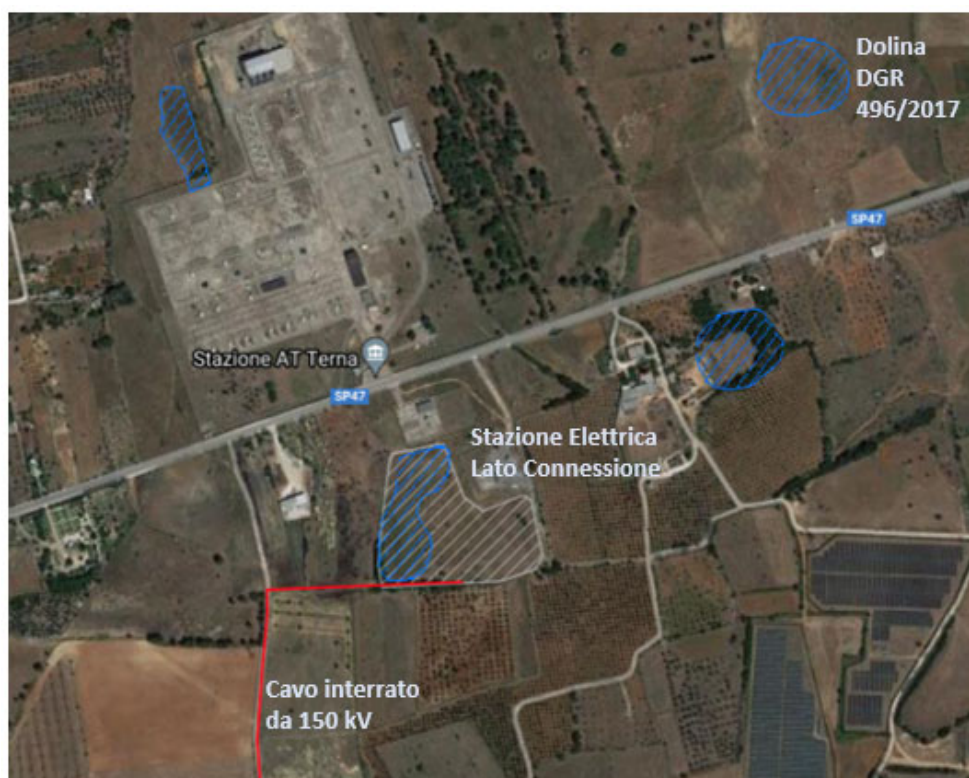
Figura 4.5: Presenza dolina in area Stazione Elettrica Lato Connessione
