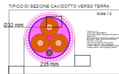
Figura 3.3: Esempio di cavo di collegamento a 66 kV e tipici di sezione
