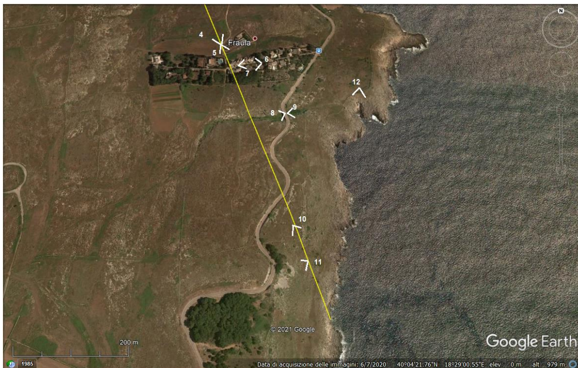
Figura 4-25: Localizzazione della traccia cavidotti fino al punto di spiaggiamento (linea gialla). Sono indicati i punti di vista fotografici descritti nel testo.
