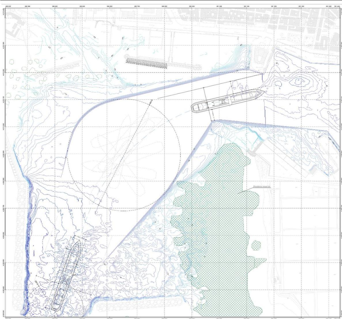
Figura 38. Sovrapposizione di una possibile rotta di ingresso della nave di progetto con l'assetto dell'avamposto e dell'imboccatura al bacino interno risultante dalle operazioni di salpamento della testata e di parte del tronco dello sporgente Ronciglio.
