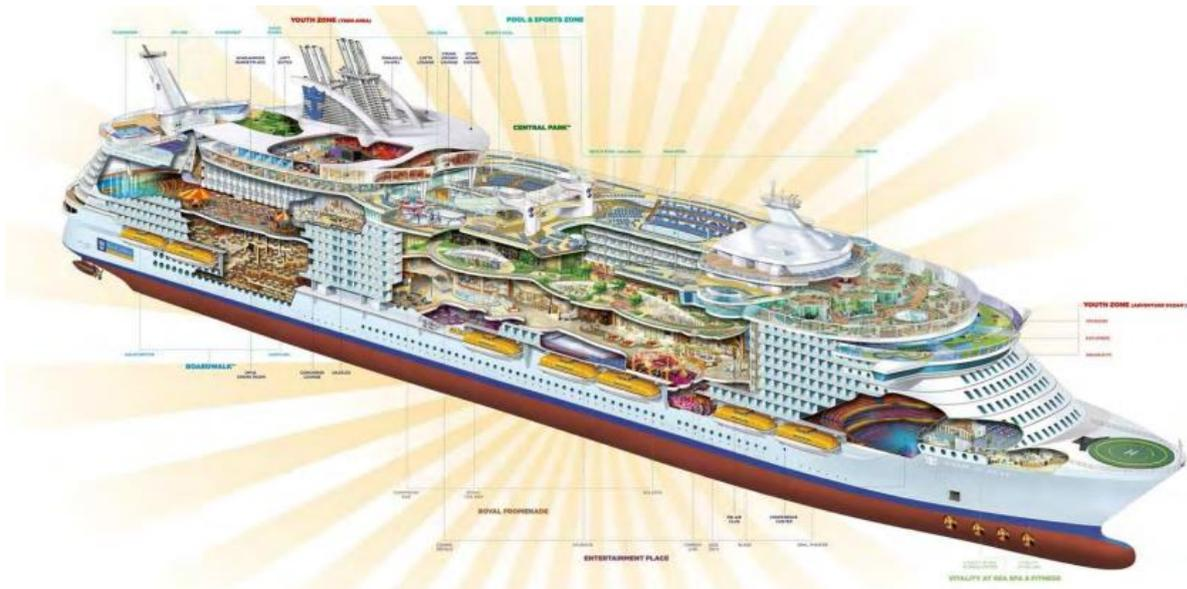
Figura 8. Spaccato della "Oases of the Seas" (caratteristiche principali: Stazza lorda 225'282 ton; L<sub>OA</sub> 362 m; B<sub>OA</sub> 47 m; Altezza massima 72 m; Pescaggio 9,3 m; Equipaggio 2165; Passeggeri in massima occupazione 5400) con sviluppo dei ponti cabina al disopra della linea di galleggiamento.
