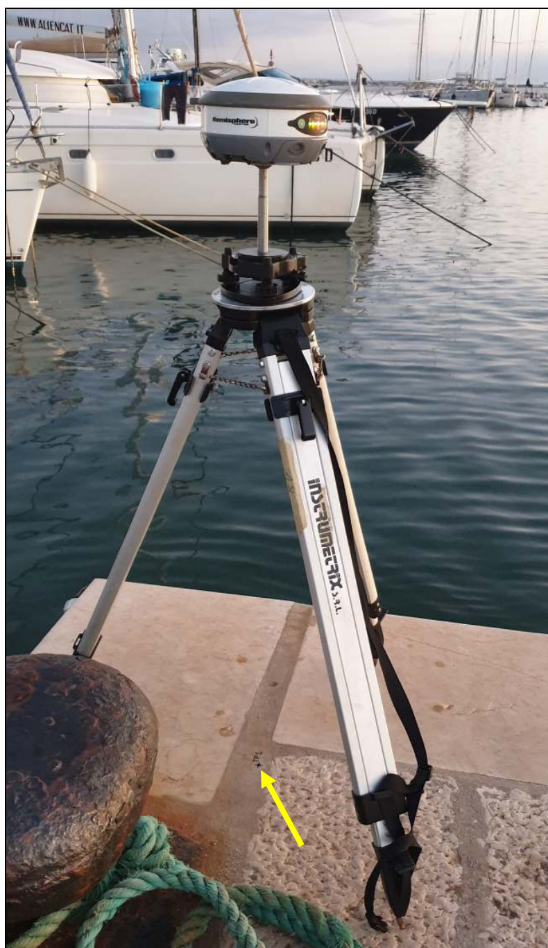
Figura 4.3 - Hemisphere S320 GNSS Survey Receiver installato su treppiede durante la verifica del sistema di posizionamento sul punto denominato TP1 (freccia gialla).
