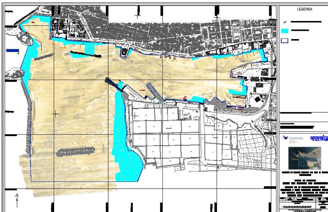
Figura 7.1 - Carta del mosaico dei sonogrammi dell'area di deposizione, n°1 fogli, scala 1:2500, con: planimetria, immagine TIFF del mosaico e area commissionata.
