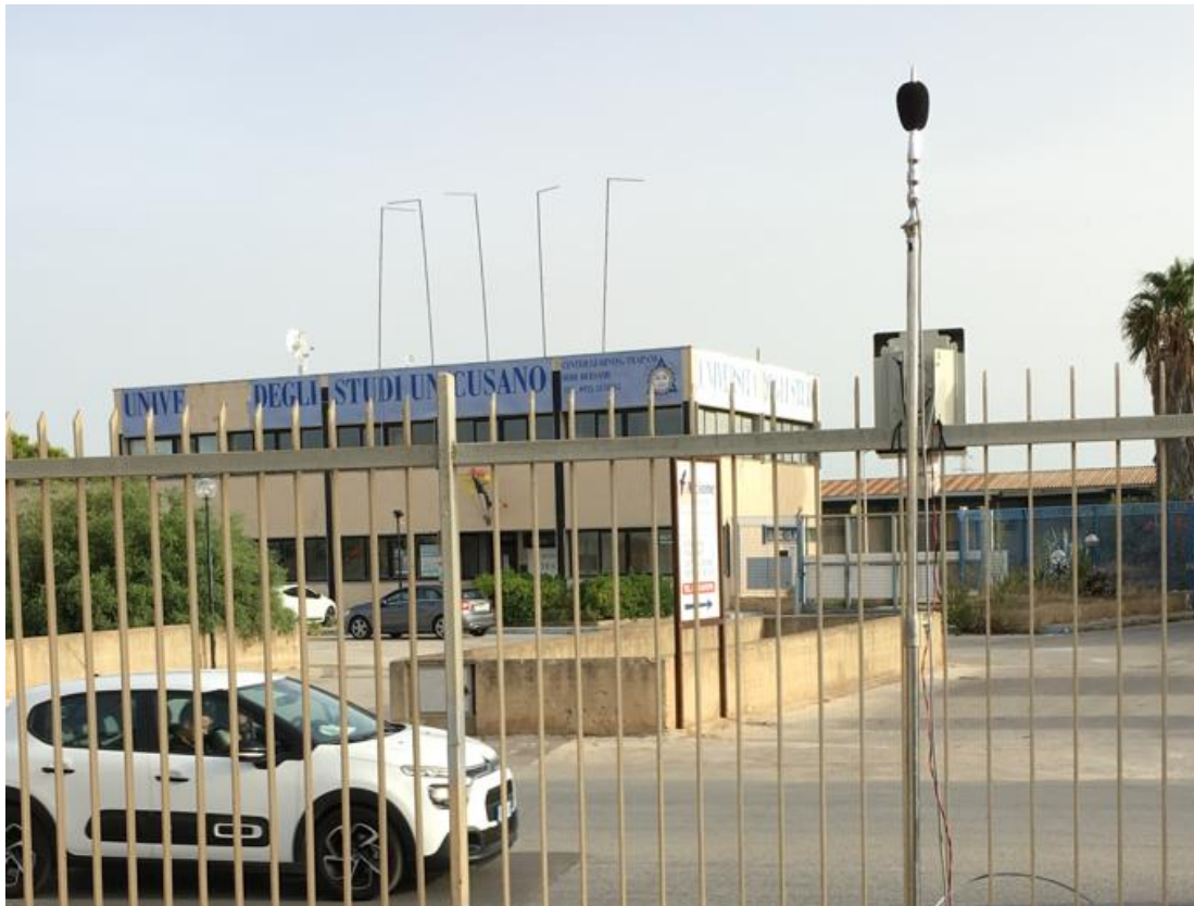
Figura 2-3 Postazione di misura traffico veicolare e rumore presso punto PR2
