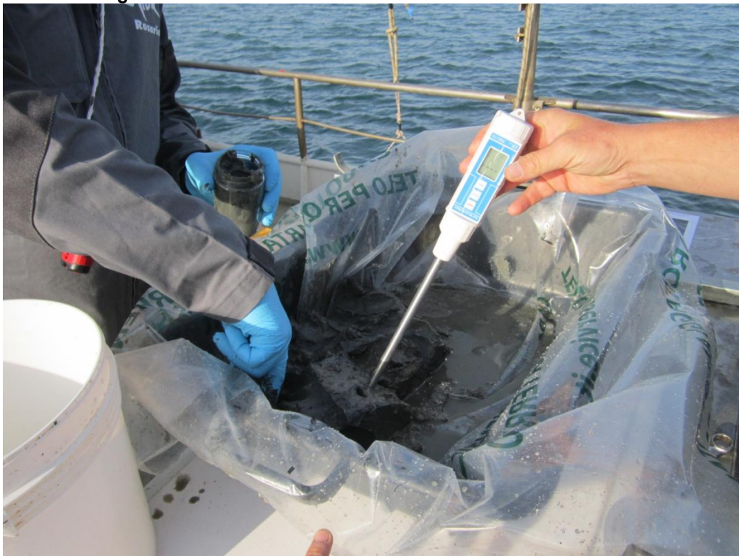
Figura 15. Misure da campo sul campione "fresco" tal quale appena prelevato
