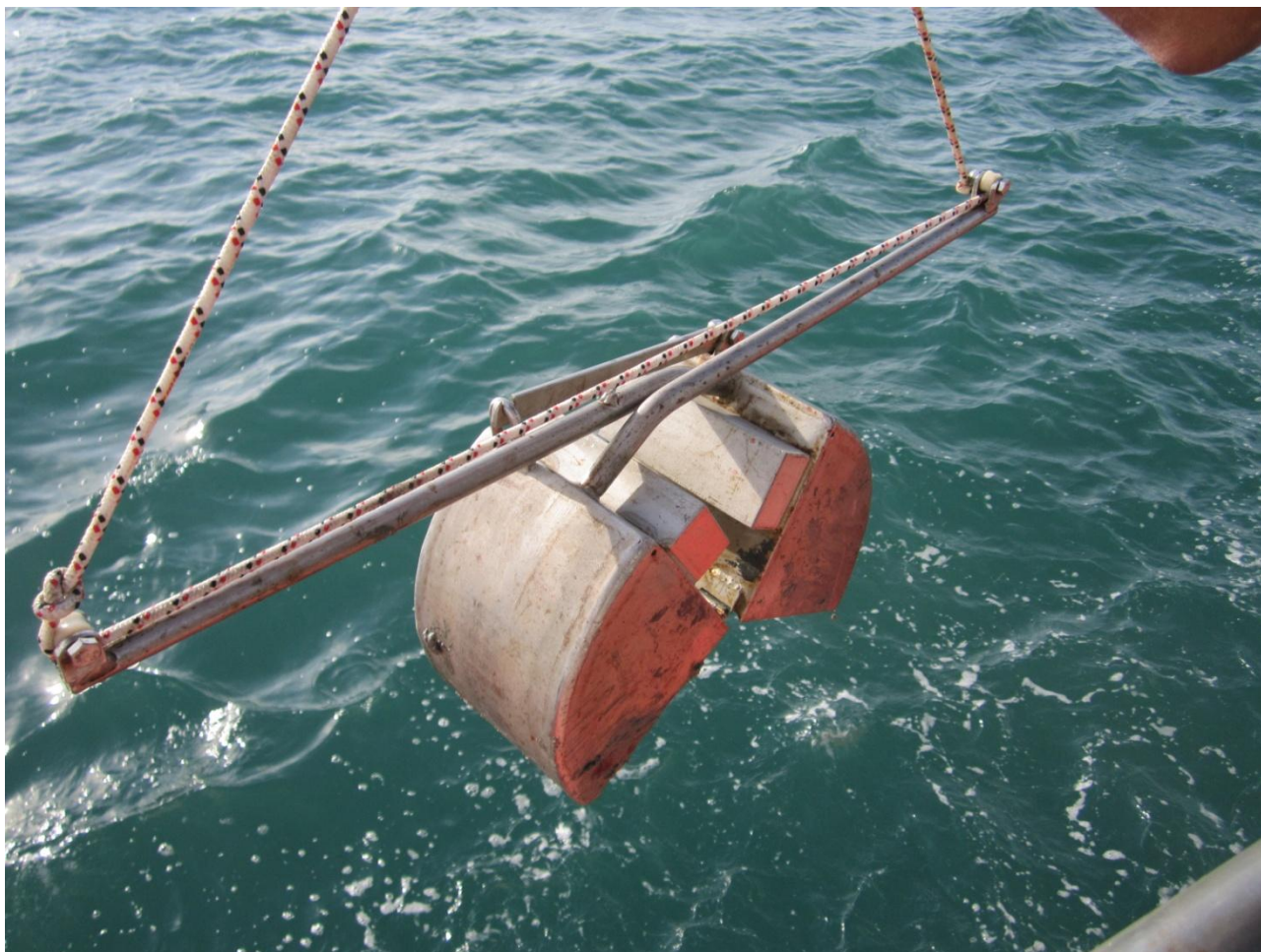
Figura 16. Benna di Van Veen montata su argano di supporto utilizzata per le fasi di prelievo dei sedimenti superficiali presso il porto di Trapani
