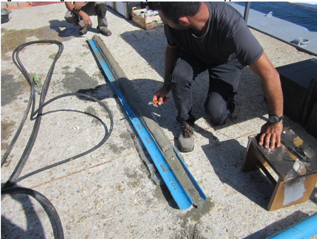
Figura 12. apertura longitudinale del liner interno al carotiere
