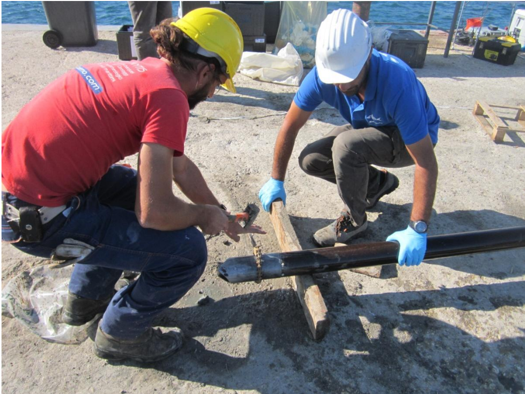
Figura 11. Dettaglio della modalità di apertura del "naso trappola" del vibrocarotiere
