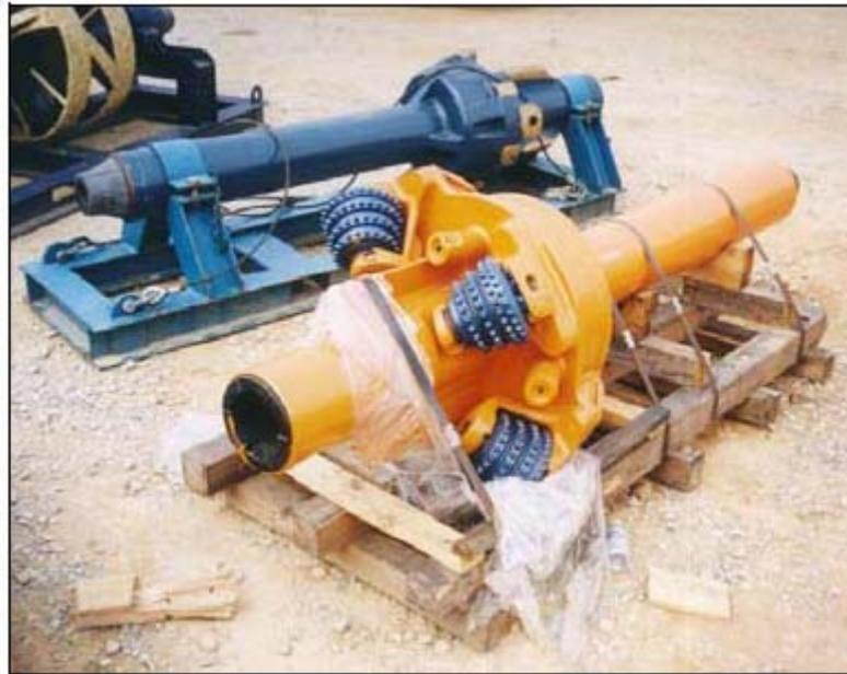
L'ultima fase consiste nel tirare la condotta all'interno del foro alesato ed avviene collegando la colonna di varo (di lunghezza pari alla lunghezza del foro) al treno di aste di perforazione.
