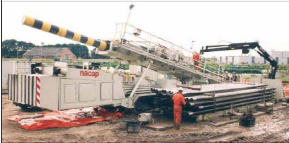
Alla stringa dell'asta di perforazione viene fissato un dispositivo per l'alesaggio. Il dispositivo di alesaggio allarga il foro e lo rende regolare, fino a raggiungere il diametro voluto. Generalmente in terreni rocciosi l'alesaggio viene effettuato per mezzo di un *hole-opener* (si veda la figura seguente).
