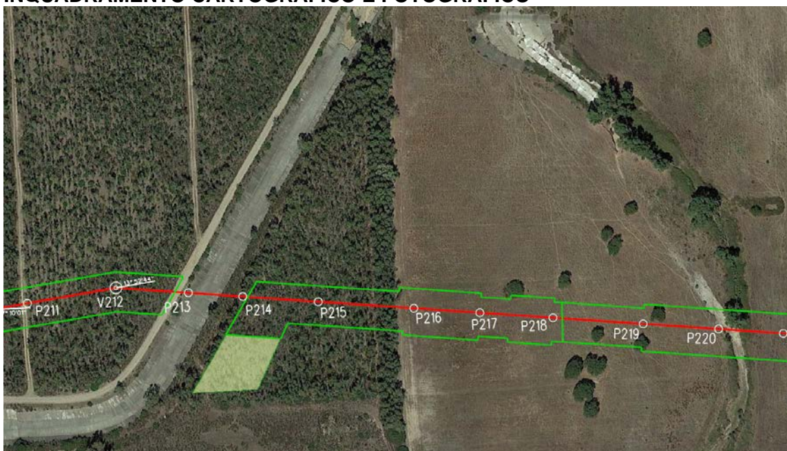
FOTO AEREA 3: Tratto P214 - P215+41mt- la zona delimitata dalle linee verdi rappresenta la fascia ristretta di lavoro per come previsto dalla GASD C 13.40.10.02
