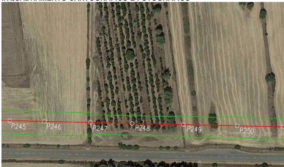
FOTO AEREA 5: Tratto P247 – P249+10mt - la zona delimitata dalle linee verdi rappresenta la fascia ristretta di lavoro per come previsto dalla GASD C 13.40.10.02
