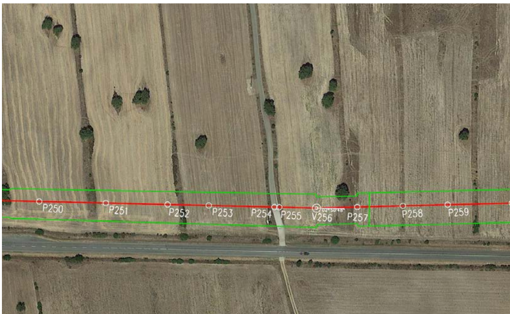
FOTO AEREA 7: Tratto P252 – P252+7mt - la zona delimitata dalle linee verdi rappresenta la fascia ristretta di lavoro per come previsto dalla GASD C 3.40.10.02
