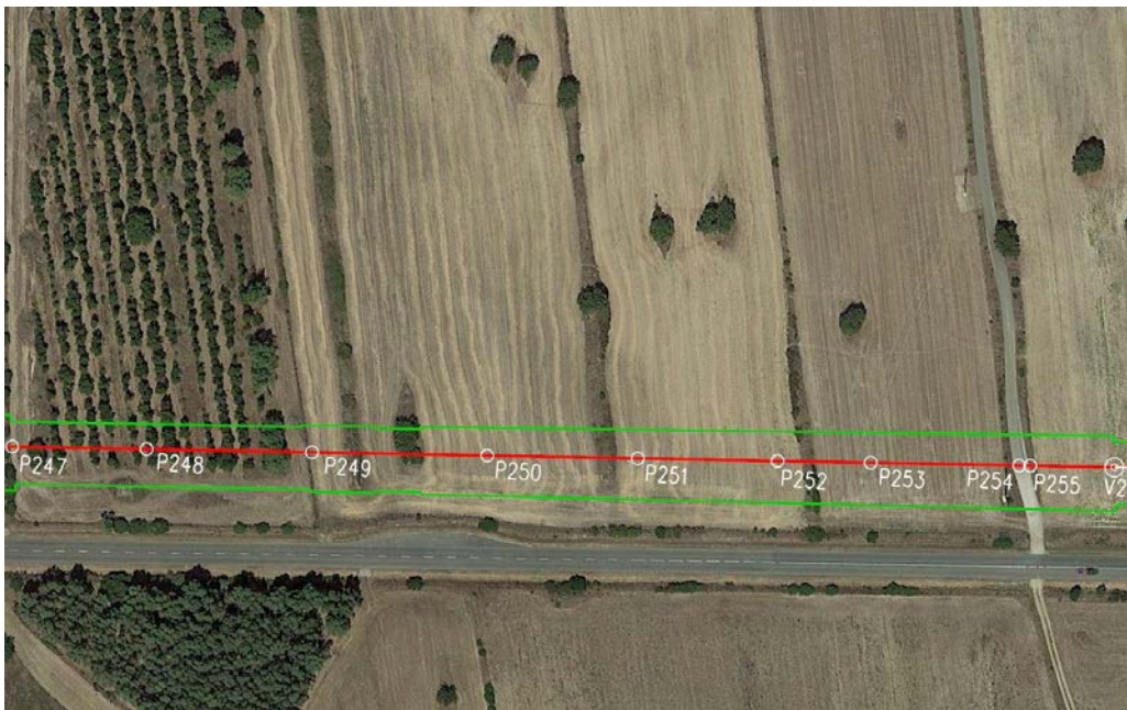
FOTO AEREA 6: Tratto P249+20mt – P249+35mt - la zona delimitata dalle linee verdi rappresenta la fascia ristretta di lavoro per come previsto dalla GASD C 13.40.10.02
