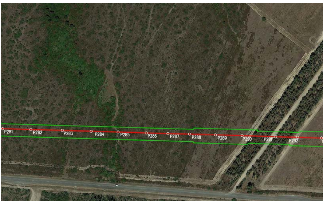
FOTO AEREA 13: P284- P285 - la zona delimitata dalle linee verdi la fascia ristretta di lavoro per come previsto dalla GASD C 13.40.10.02
