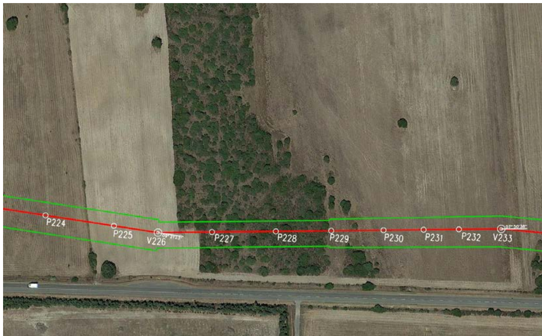
FOTO AEREA 3: Tratto V226+20mt – P227 - la zona delimitata dalle linee verdi rappresenta la fascia ristretta di lavoro per come previsto dalla GASD C 13.40.10.02
