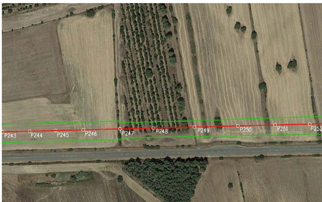
FOTO AEREA 5: Tratto P247 – P249 - la zona delimitata dalle linee verdi rappresenta la fascia ristretta di lavoro per come previsto dalla GASD C 13.40.10.02
