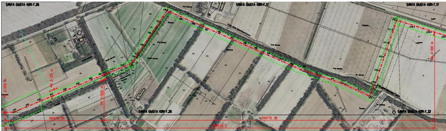
Figura 2.2/C: Met. Coll. Terminale di Oristano DN 650 (26'') - Tratto 3 e relativi sottotratti su ortofoto e base catastale.
