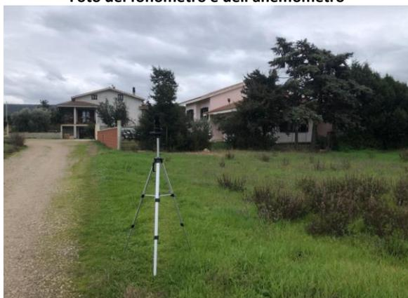
Foto del fonometro e dell'anemometro
