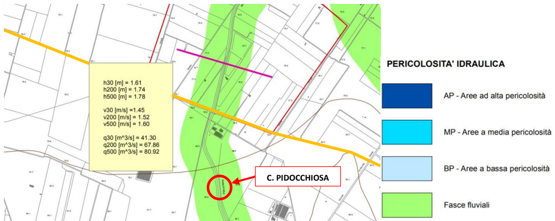
Figura 2.6: Stralcio carta di pericolosità idraulica nr. 186 "Stornara" del PGRA aggiornata al 30/03/2016. In arancione il percorso di connessione.
