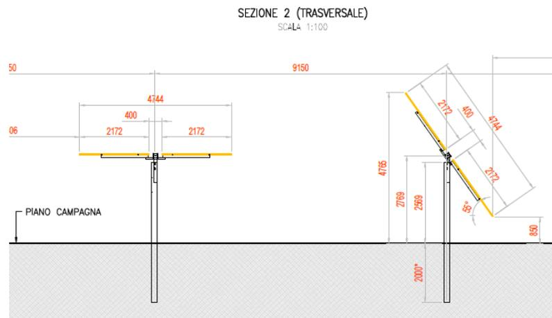
Figura 4.4: Particolare strutture di sostegno moduli
