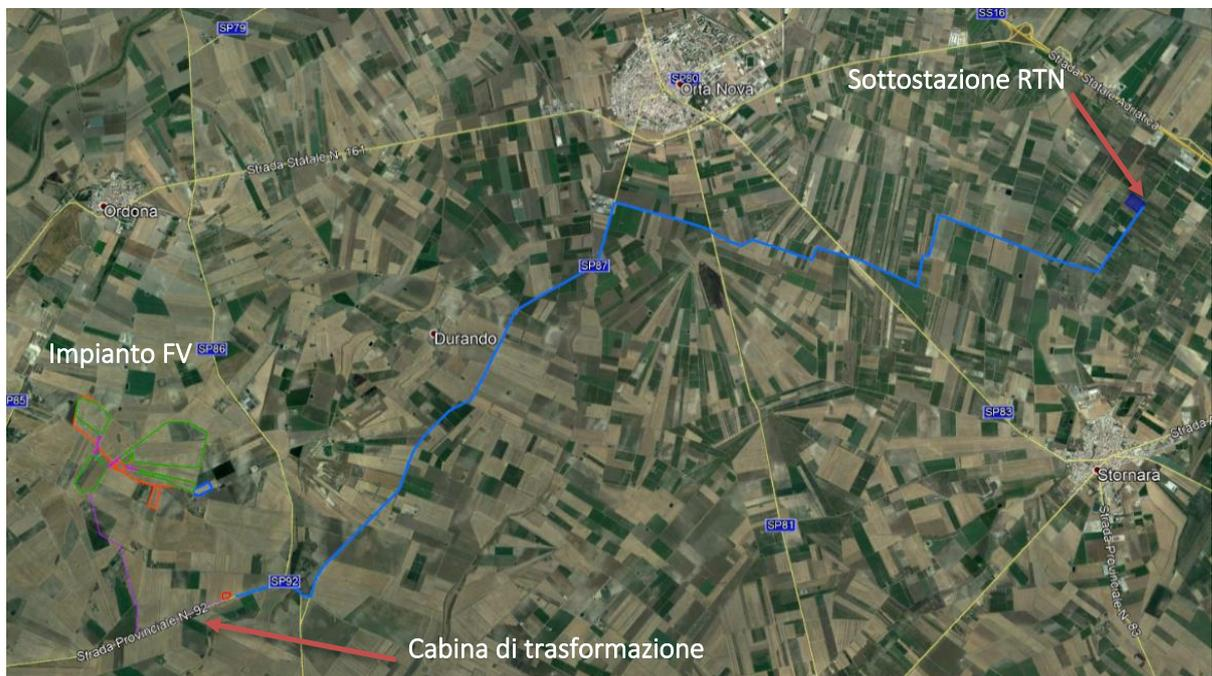
Figura 4.9: In viola il percorso di connessione dal campo FV alla cabina di trasformazione e in blu il successivo collegamento alla Sottostazione AT di Stornara
