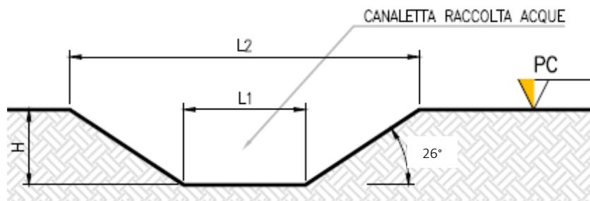
Figura 7.1: Sezione tipologica canaletta di drenaggio realizzata in scavo.
