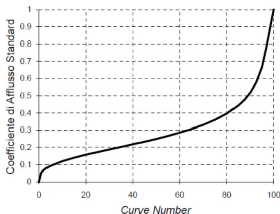
Figura 6.7: Correlazione da letteratura SCS-CN vs. coeff. afflusso/deflusso.
