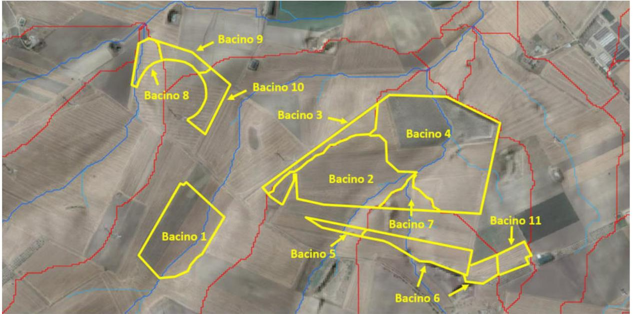
Figura 6.9: Delimitazione aree di impianto e rete di drenaggio naturale interna.
