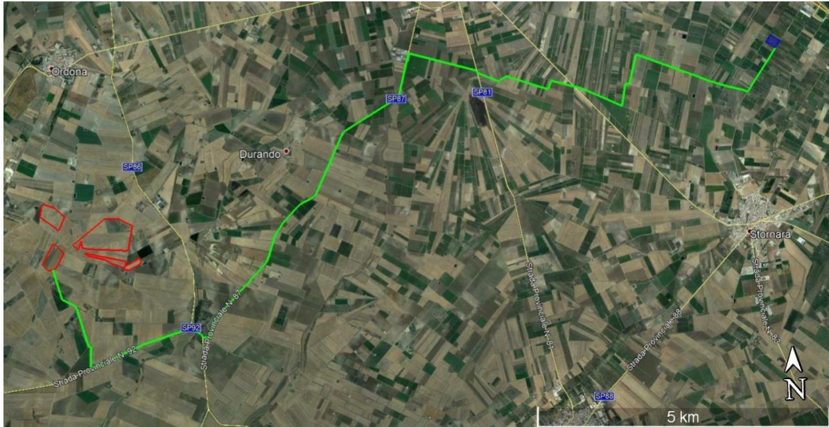
Figura 4.2: Area di progetto (rosso) e percorso di connessione (verde) alla cabina SSE Stornara (blu).
