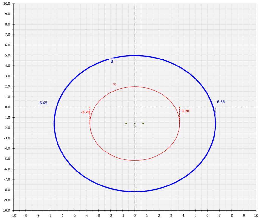
**Figura 8:**      **Calcolo della DPA (caso di cavo da 400 mm<sup>2</sup>)**
