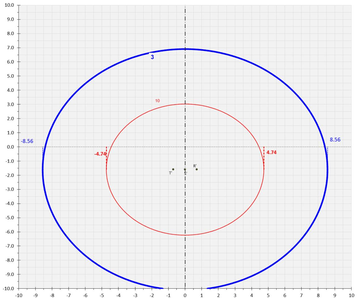
**Figura 9:**      **Calcolo della DPA (caso di cavo da 1600 mm<sup>2</sup>)**
