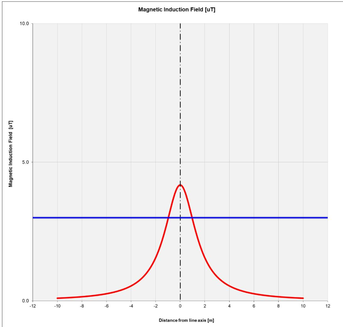
**Figura 4:** *Andamento dell'induzione magnetica prodotta dalla linea in cavo AT (caso di cavo da 400 mm<sup>2</sup>)*
