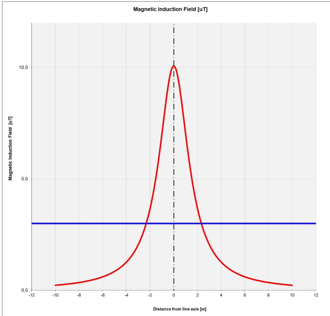
**Figura 5:** *Andamento dell'induzione magnetica prodotta dalla linea in cavo AT (caso di cavo da 1600 mm<sup>2</sup>)*
