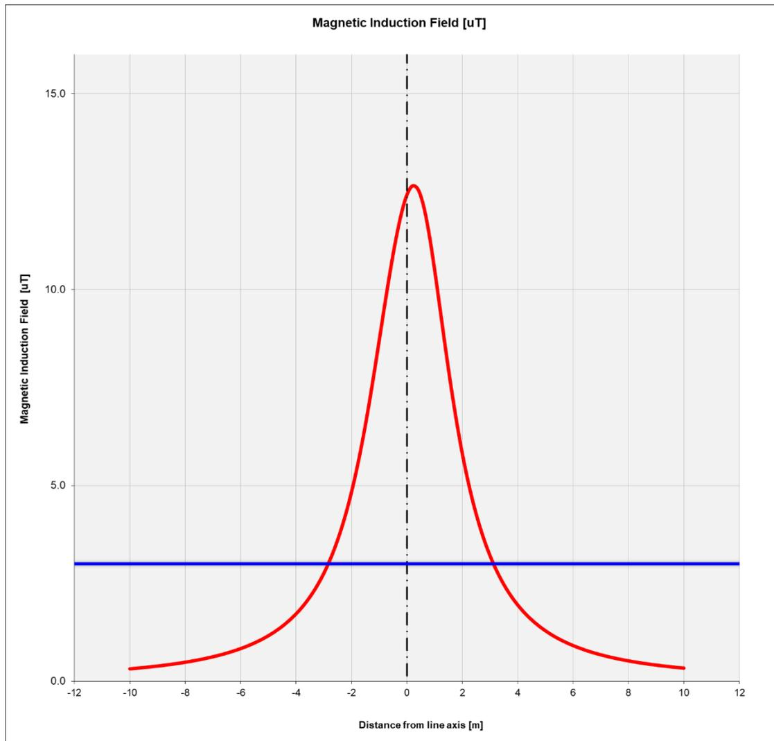
**Figura 6:** *Andamento dell'induzione magnetica prodotta dalla linea in cavo AT (caso di cavo da 1600 con cavo da 400 mm<sup>2</sup>)*
