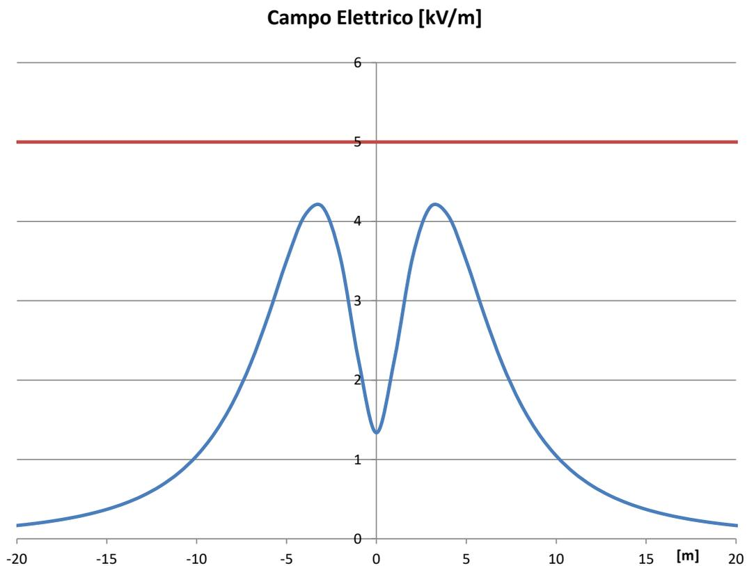
**Figura 1:** Campo elettrico al suolo generato dal sistema di sbarre a 150 kV
