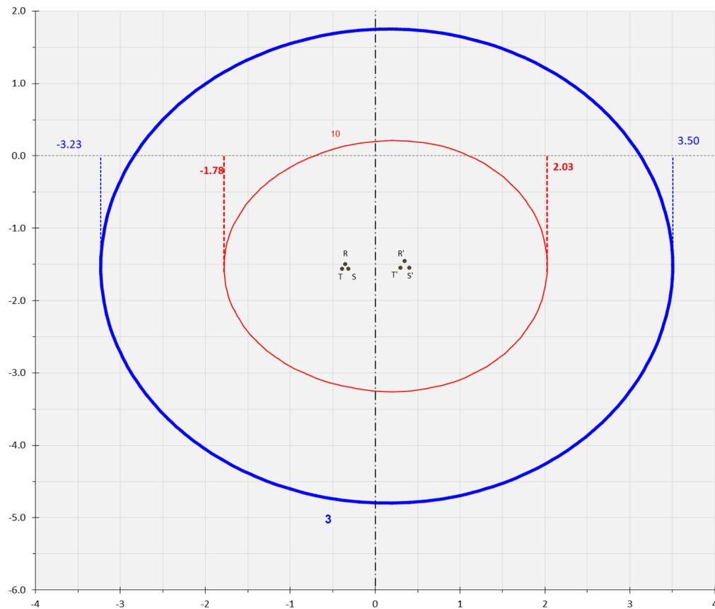
**Figura 7:** *Calcolo della DPA (caso di cavo da 1600 con cavo da 400 mm<sup>2</sup>)*
