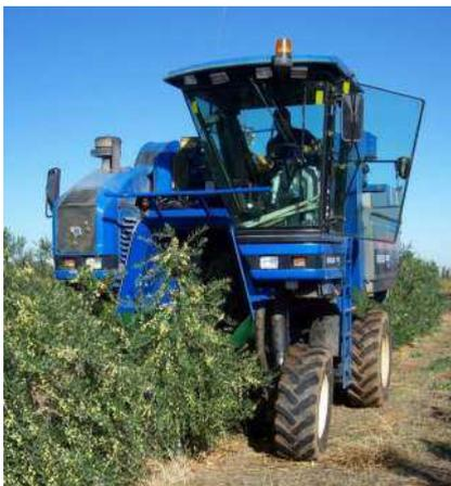
Fig.9: Macchina scavallatrice
