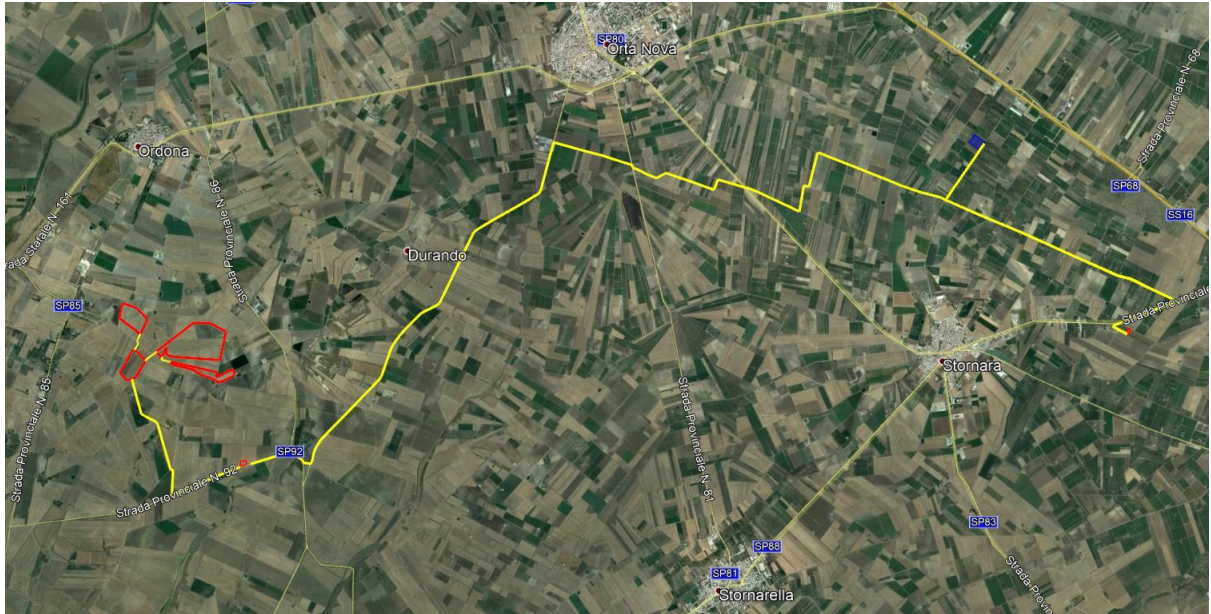
Figura 2.2: Localizzazione dell'Area di Intervento, in rosso la recinzione dell'impianto, in giallo la linea di connessione
