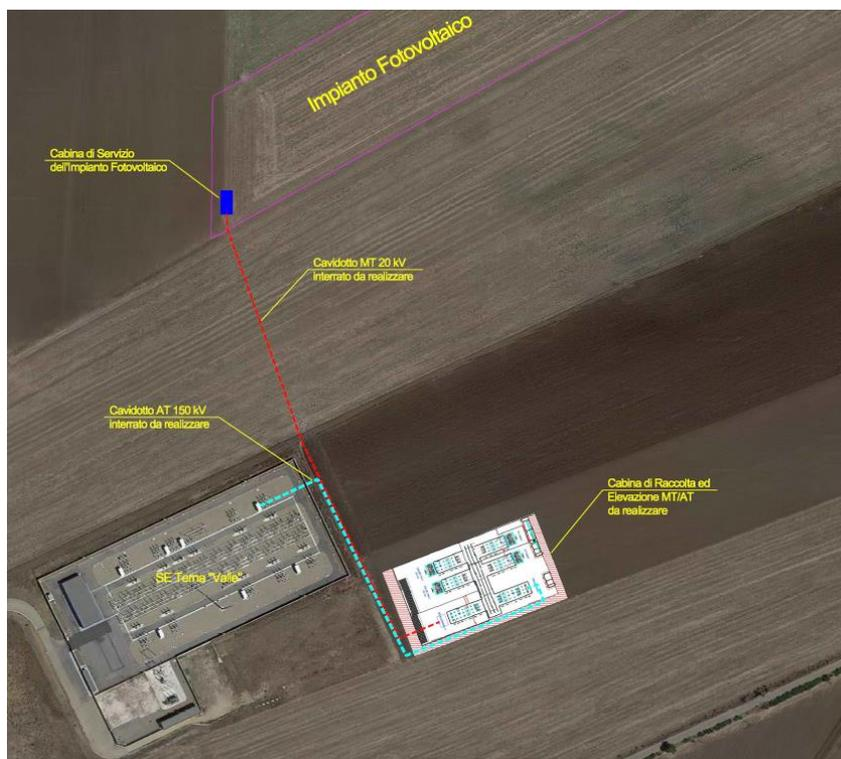
Figura 3.7: percorso di connessione dal campo FV alla cabina di trasformazione (rosso\_MT; ciano=AT)
