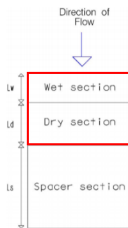
Figura 5.8: Modulo tipo, descrivente il modello concettuale idrologico dell’installazione di strutture fotovoltaiche a tracker su pali infissi comprendente l’area pannelli (in rosso) e l’area di interfila (Fonte: Hydrologic response of solar farm Cook 2013 American Society of Civil Engineers).
