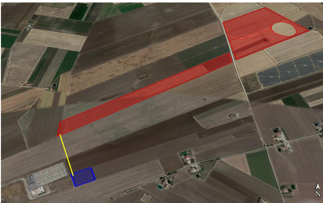
Figura 4.2: Area di progetto (rosso), percorso di connessione (giallo) e cabina di trasformazione (blu).
