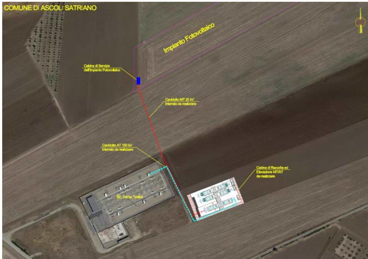
Figura 3.1: Rilievo Linea di Connessione
