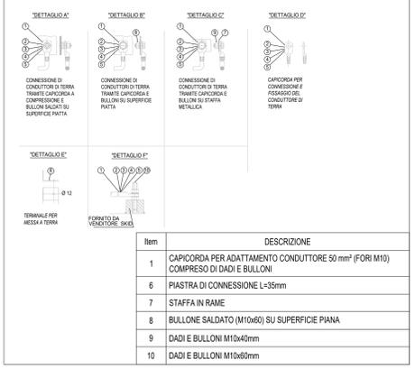
CONDUTTORI METALLICI SALDATI
