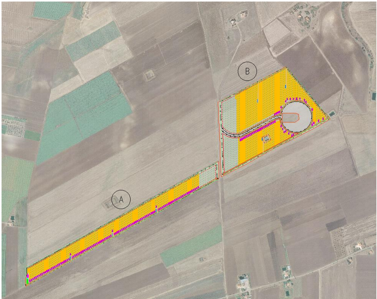
Figura 2.4: Layout di progetto area impianto FV
