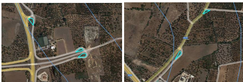
Figura 7: stralci dell'ortofoto Google Earth con sovrapposizione del buffer di 150 m del Torrente Valenzano. All'interno del buffer sono presenti fabbricati adibiti ad attività produttive, svincoli della Strada Statale n. 100, tratti della SP 65 e della SP 79. In ciano i quattro allargamenti della viabilità esistente in progetto che si riferiscono in tre casi a sistemazioni temporanee delle aiuole interne agli svincoli stradali e in un caso ad un adeguamento temporaneo di un incrocio tra la SP n. 179 e la strada comunale Guidotti.
