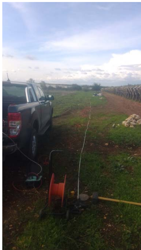
Sondaggio Sismico MASW4
