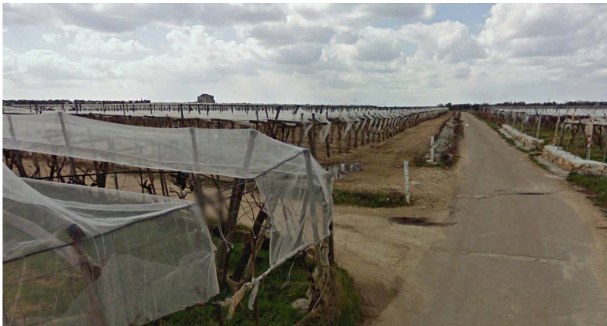
Figura 15: imbocco della strada interpodereale in massiciata e finitura in stabilizzato da cui si serve l'aerogeneratore A05, vista dalla strada asfaltata; l'imbocco dovrà essere allargato per consentire il transito dei mezzi di trasporto delle strutture. La strada sarà percorsa anche dal cavidotto interrato.
