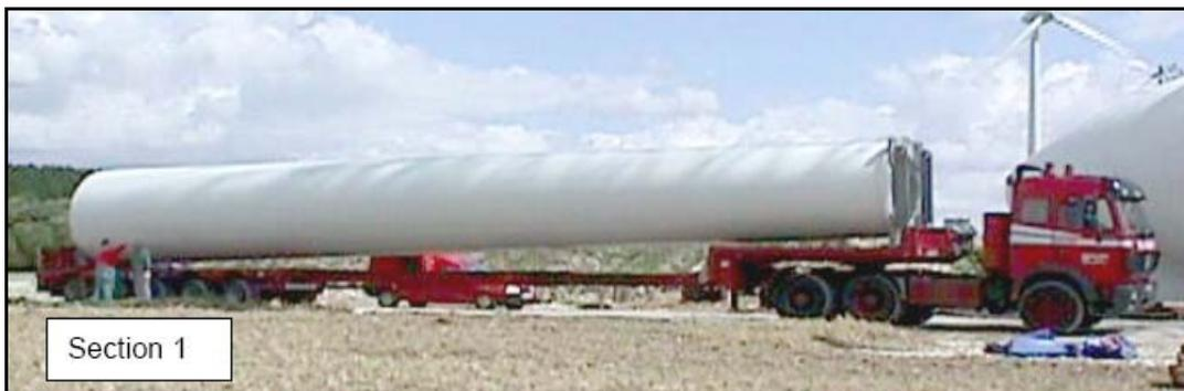
**Figura 12:** trasporto della sezione della torre
