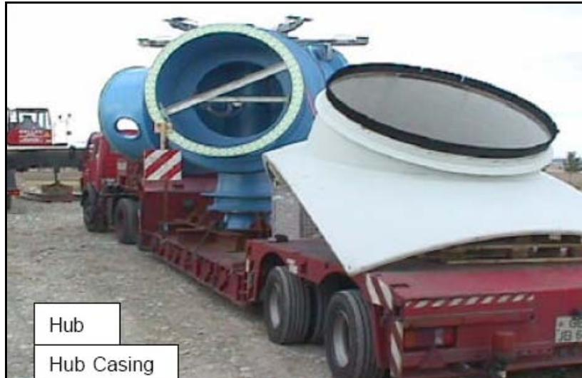
**Figura 11:** trasporto del mozzo
