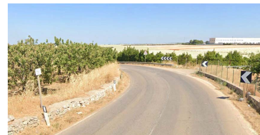
Figura 6: la foto mostra la strada che permette l'accesso all'aerogeneratore A04 in corrispondenza della Masseria Panicelli. In tale tratto sarà necessario effettuare delle operazioni di adeguamento stradale consistenti nella rimozione della recinzione che si trova sul lato opposto alla masseria, sulla destra nella foto, con temporaneo allargamento della carreggiata stradale.
