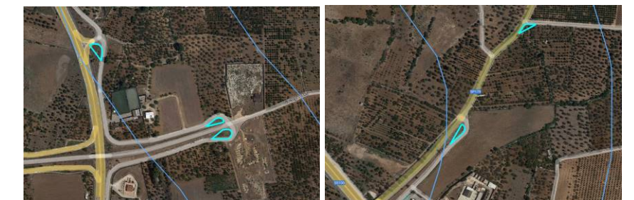
Figura 4: stralci dell'ortofoto Google Earth con sovrapposizione del buffer di 150 m del Torrente Valenzano. All'interno del buffer sono presenti fabbricati adibiti ad attività produttive, svincoli della Strada Statale n. 100, tratti della SP 65 e della SP 79. In ciano i quattro allargamenti della viabilità esistente in progetto che si riferiscono in tre casi a sistemazioni temporanee delle aiuole interne agli svincoli stradali e in un caso ad un adeguamento temporaneo di un incrocio tra la SP n. 179 e la strada comunale Guidotti.
