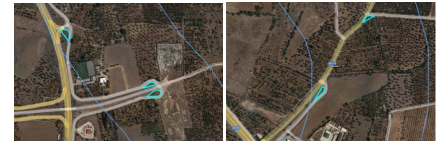
Figura 8: stralci dell'ortofoto Google Earth con sovrapposizione del buffer di 150 m del Torrente Valenzano. All'interno del buffer sono presenti fabbricati adibiti ad attività produttive, svincoli della Strada Statale n. 100, tratti della SP 65 e della SP 79. In ciano i quattro allargamenti della viabilità esistente in progetto che si riferiscono in tre casi a sistemazioni temporanee delle aiuole interne agli svincoli stradali e in un caso ad un adeguamento temporaneo di un incrocio tra la SP n. 179 e la strada comunale Guidotti.
