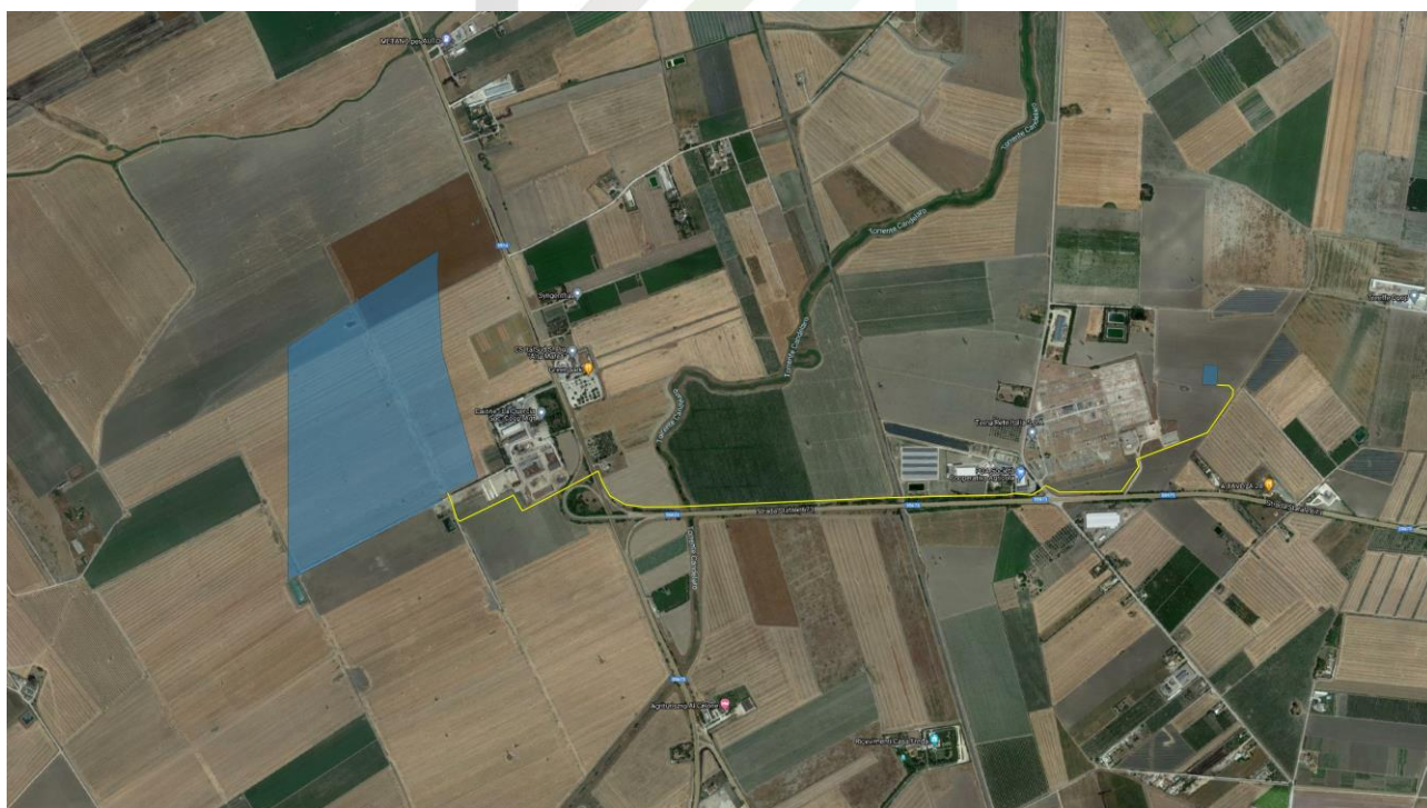
Figura 4-1: Aree Protette EUAP, in blu la perimetrazione dell'impianto, in giallo il tracciato della connessione
