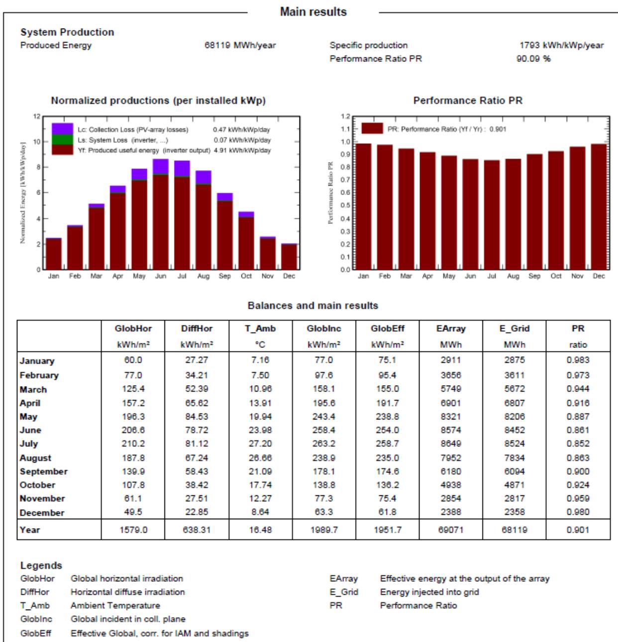
Sulla scorta di tutte le considerazioni effettuate nei paragrafi precedenti, è stato effettuato il calcolo della producibilità del sistema, partendo dal modello dell'impianto imputato nel software di calcolo PVSyst.
