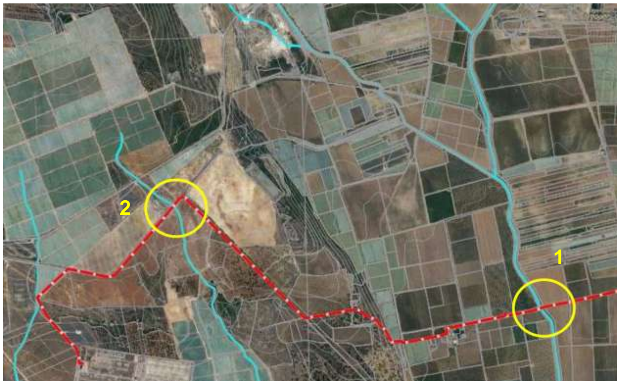
Figura 7 Inquadramento delle intersezioni del cavidotto con i reticoli idrografici sulla carta idrogeomorfologica della Regione Puglia redatta dell'AdB –Vista di dettaglio.
