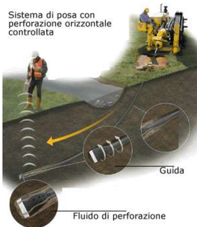
Figura 9– Sistema di trivellazione orizzontale controllata (T.O.C.) .
