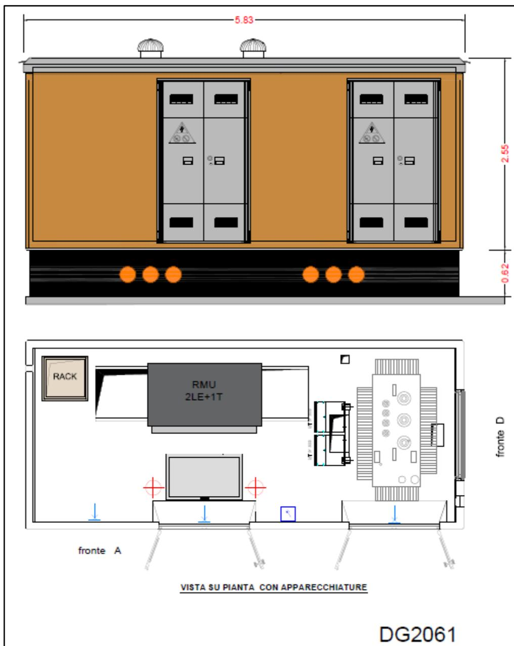
Figura 25 Tipologico Cabina di Sezionamento
