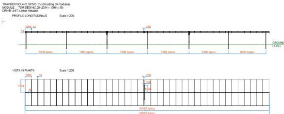
Figura 14: Configurazione Struttura tracker 2x39
