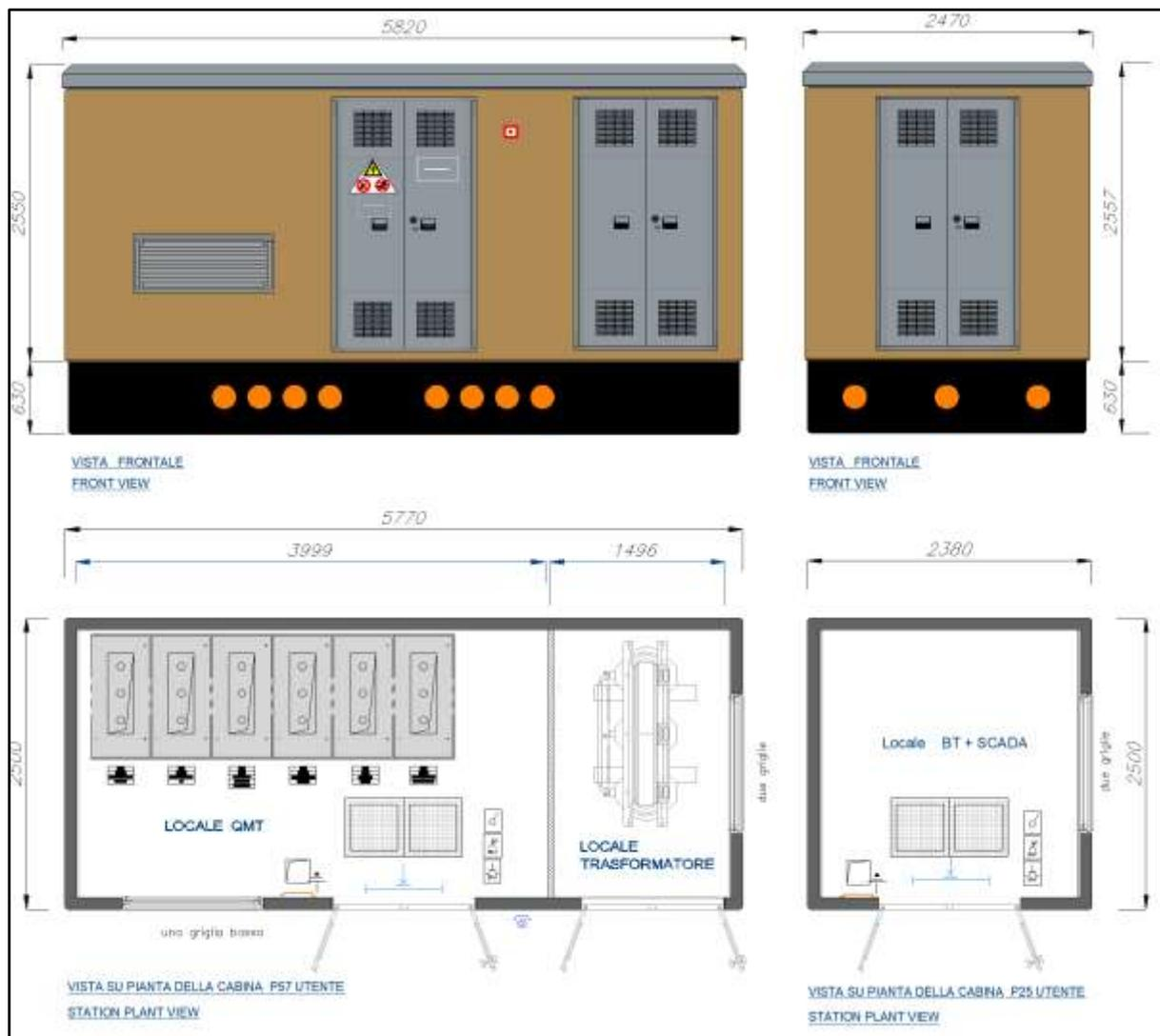
Figura 26 Cabina Utente (MT -TSA) e (SCADA - bt)
