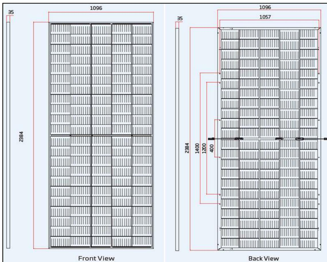
Figura 12 Dimensioni modulo "TSM-DEG19C.20"
